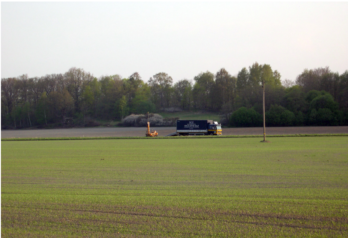
Fig. 6. Undersökningar av grundvattenförekomster vid Norsborg. Under ett täckande lager lera återfinns stora mäktigheter vattenmättade isälvssediment. Foto: Torbjörn Persson.
