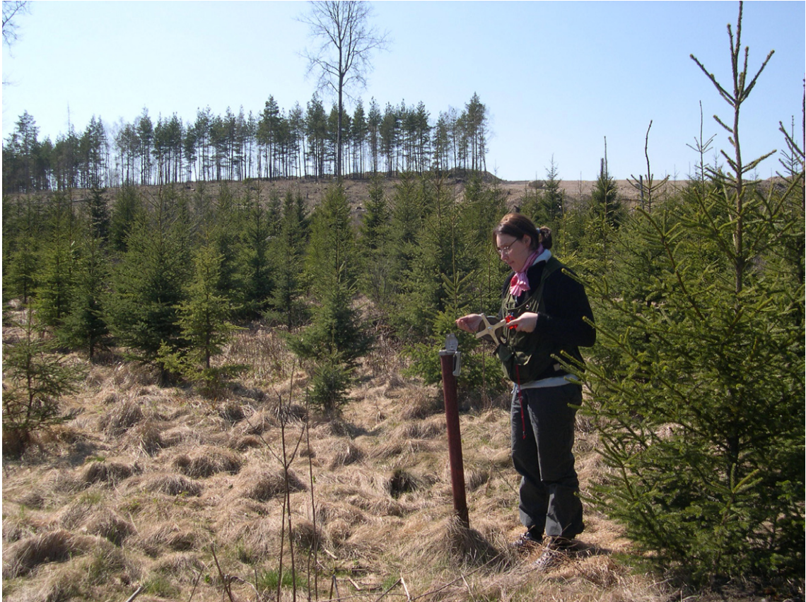
Fig. 15. Ett stort antal befintliga grundvattenrör har utnyttjats för grundvattennivåmätningar i området kring Pålamalm. Foto: Torbjörn Persson.
