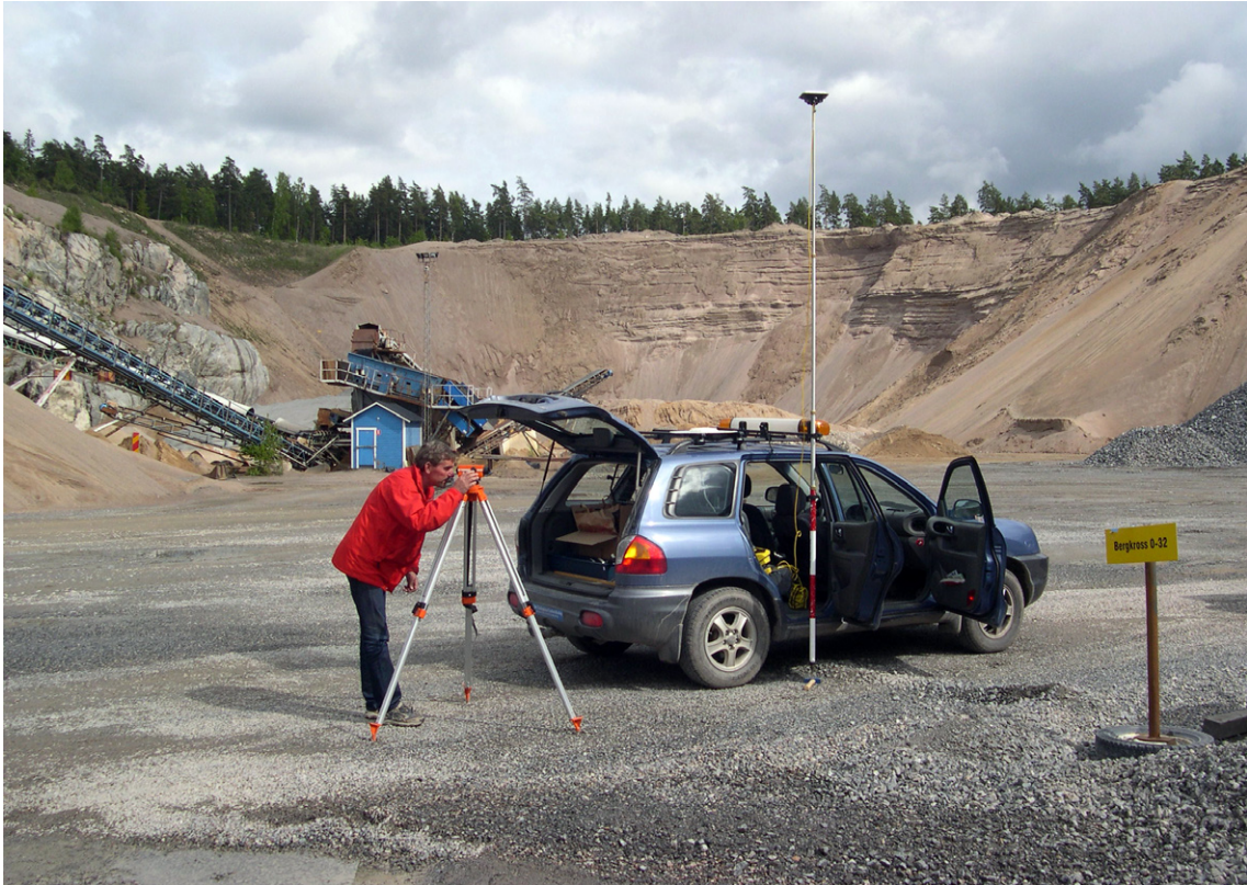
Fig. 5. För att kunna jämföra grundvattennivåer i olika grundvattenrör avvägs ett urval brunnar och grundvattenrör med hjälp av GPS. Bilden är tagen i Hamra grustäkt, Botkyrka kommun. Foto: Torbjörn Persson.
