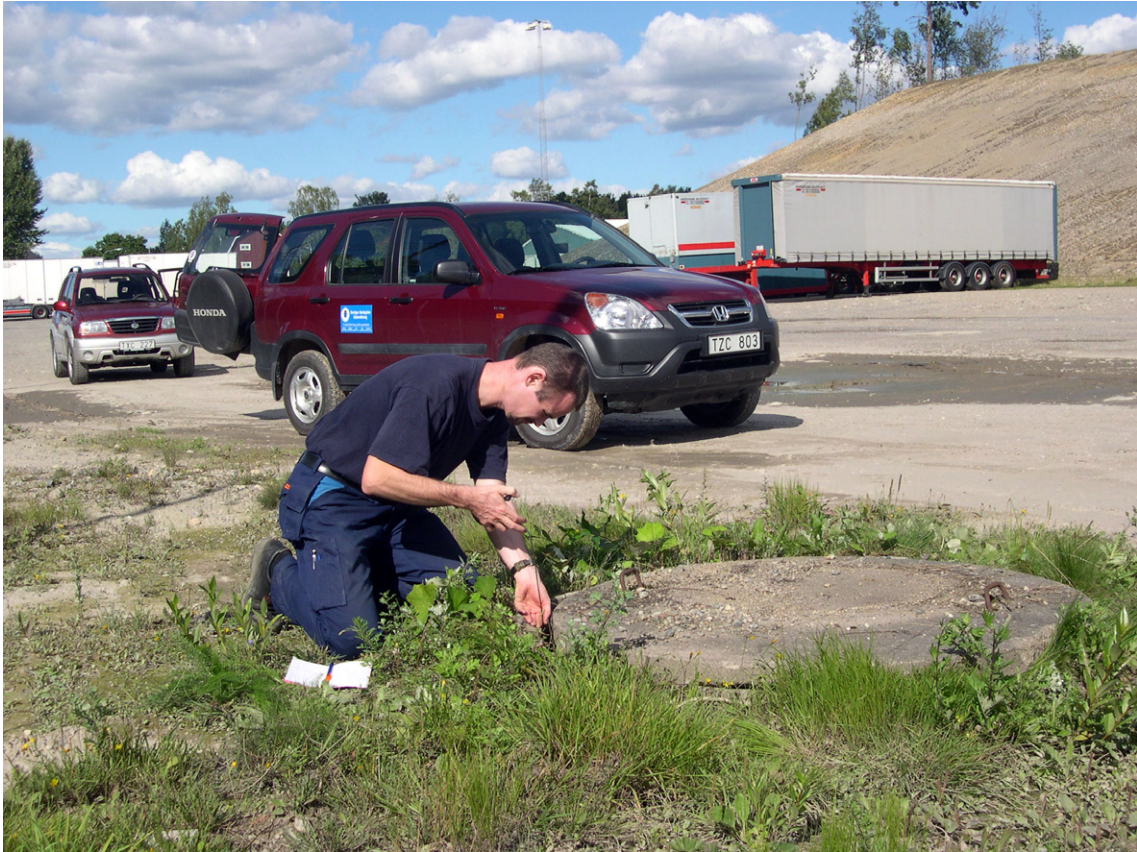
Fig. 9. Mätning av grundvattennivån strax söder om Rosenhill. Foto Torbjörn Persson.
