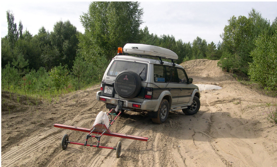
Fig. 3. Undersökning med georadar är en del av de geofysiska undersökningar som utförs. Georadarapparaturen sitter monterad på en sulky. Georadarmätningar ger information om lagerstruktur och grundvattennivå. Foto: Sune Rurling.
