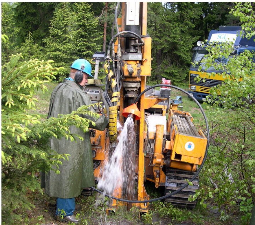
Fig. 4. Efter utvärdering av de geofysiska undersökningarna utförs borrhning i på ett urval platser. I samband med sättning av grundvattenrör kan jord- och vattenprover tas för analys från intressanta delar av lagerföljden. På bilden etableras ett grundvattenrör strax väster om sjön Axaren. Foto: Torbjörn Persson.
