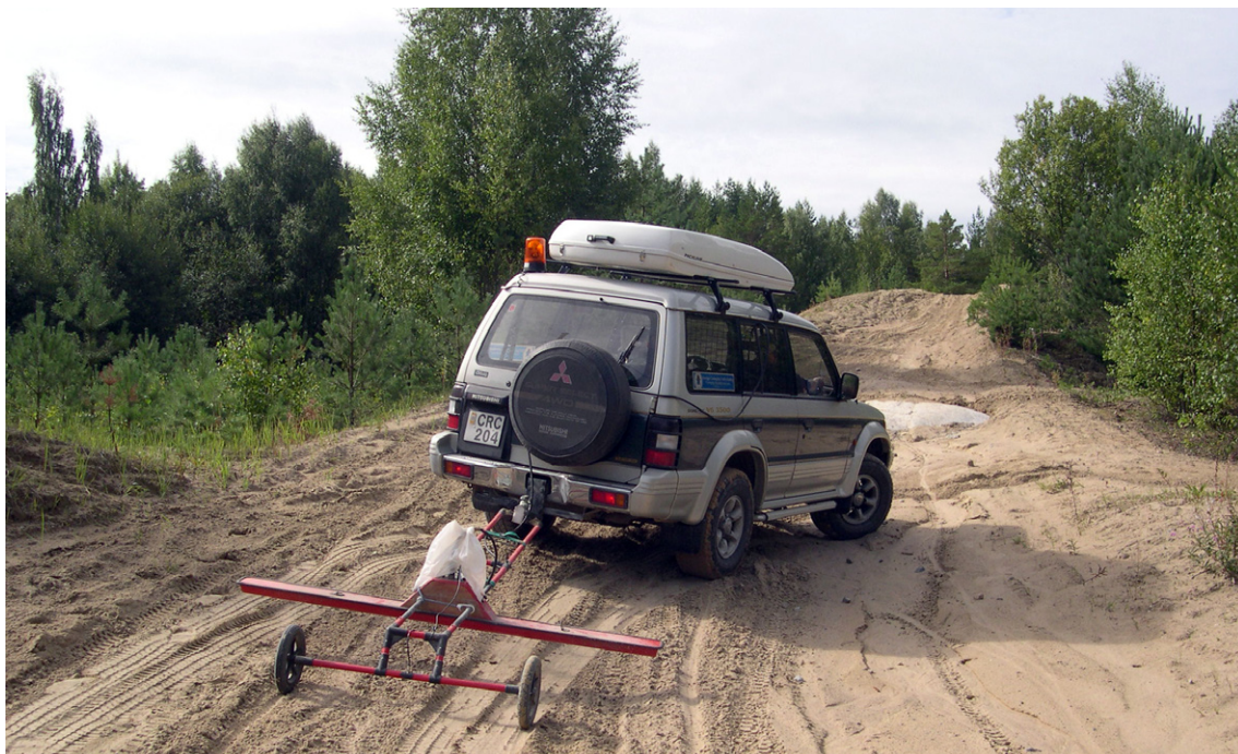
Fig. 3. Mätning med georadar är en del av de geofysiska metoder som använts. Apparaturen sitter monterad på en sulk. Georadmätningar ger information om lagerstruktur och grundvattennivå. Foto: Sune Rurling.
