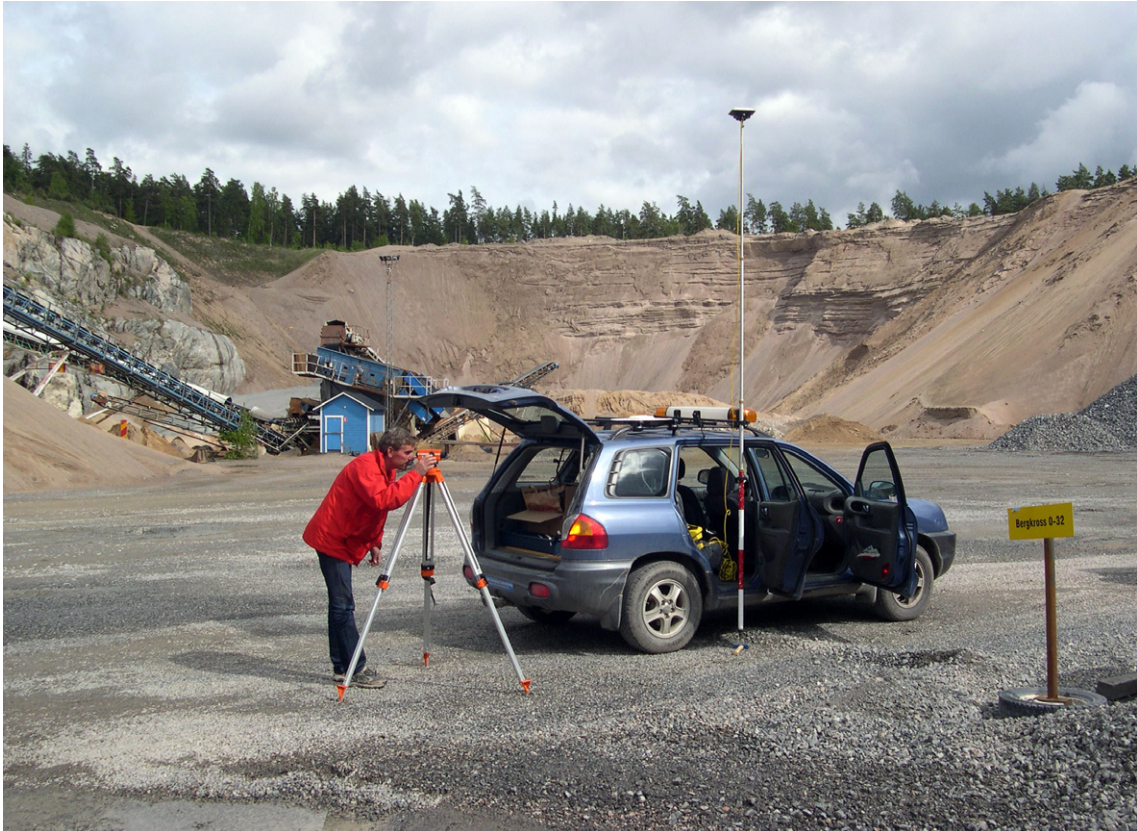
Fig. 5. För att kunna jämföra grundvattennivåer i olika grundvattenrör avvägs ett urval brunnar och grundvattenrör med hjälp av GPS. Bilden är tagen i Hamra grustäkt, Botkyrka kommun. Foto: Torbjörn Persson.
