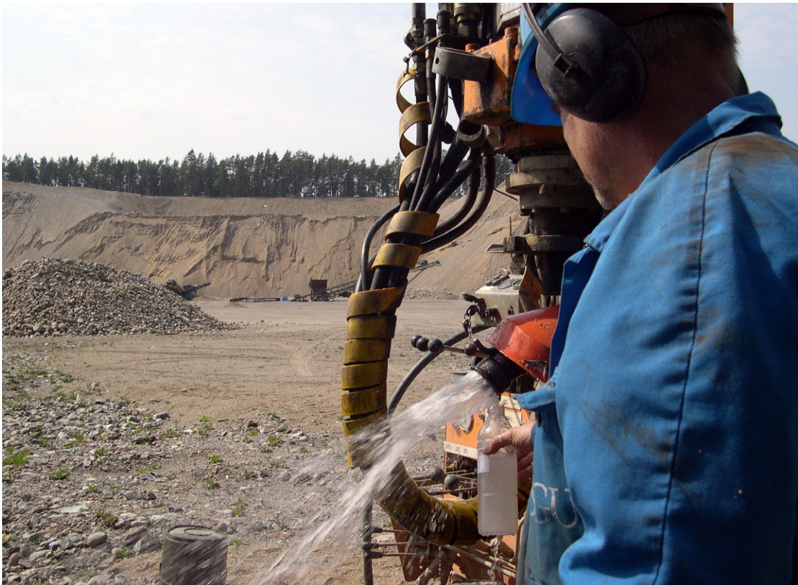
Fig. 7. Borrning och sättning av grundvattenrör i Uttrans grustag. Ingen förhöjd kloridhalt kunde noteras. Foto: Torbjörn Persson.
