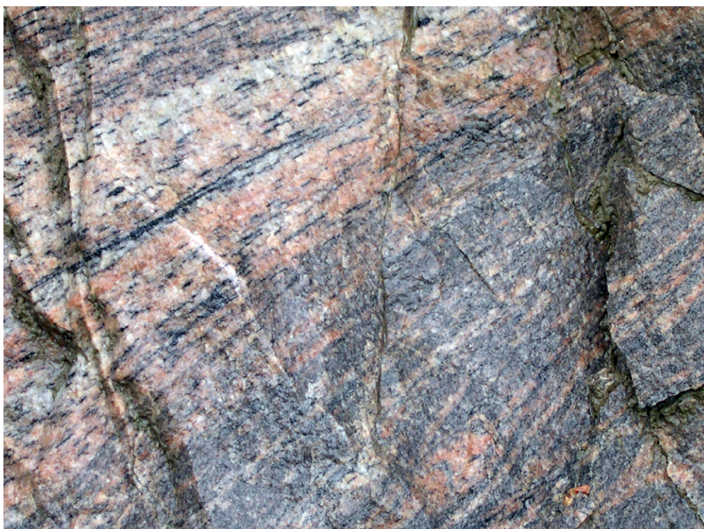
Fig. 11. Bandad, granitisk gnejs, öster om Mylonitzonen, med för området sett jämförelsevis bra tekniska egenskaper ( A_N = 12,0 \% , LA = 27,0 \% ) från Borstagärde bergtäkt (MGO035010A, 6404227/1307632). Vyn är ca 50 cm bred. Foto Mattias Göransson.
