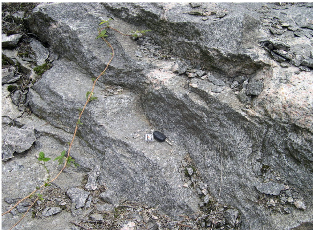
Fig. 5. Grå, grovt medelkornig, gnejsig granit till granodiorit som saknar ådring (MGO035018, 6395832/1285496). Bergarten uppvisar välutvecklade, vindlande glimmerplan vilket förmodas tillsammans med bergartens grova kornstorlek vara anledningen till bergartens dåliga tekniska egenskaper ( A_N = 21,8\% ). Nyckeln är ca 10 cm. Foto Mattias Göransson.
