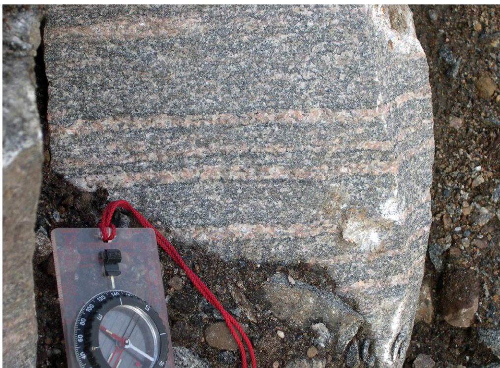
Fig. 6. Grå, fint medelkornig, ådrad granit med för området sett jämförelsevis bra tekniska egenskaper ( A_N = 13,4\% , LA = 24,8\% ) vid Rådamotet (MGO035015A, 6400402/1278618). Kompassen är 6,5 cm bred. Foto Mattias Göransson.
