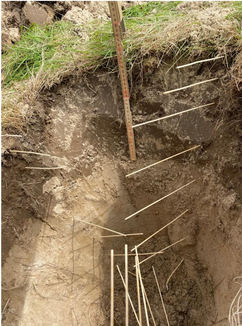
Figur 5. Jordlagerföljd, provgrop SD-ÖD2-4 i fältomgång 1. Övergång från mörkbrun, mullig sand vid 0,3 m till ljusbrun/gulbrun sand. Övergångsdjupet bedömdes till plogdjup.
