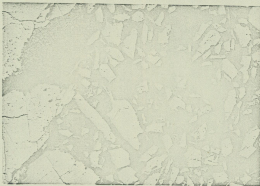
Fig. 22. Fragmentförande blodsten. Fragment av hämatit (ljusgrå) i en matrix av klorit (svart) och kvarts (mörkgrå). I övre, högra hörnet ett martitfragment. Borrhål 23, 44.5 m. Polerprov. Vanl. ljus, x 43.
