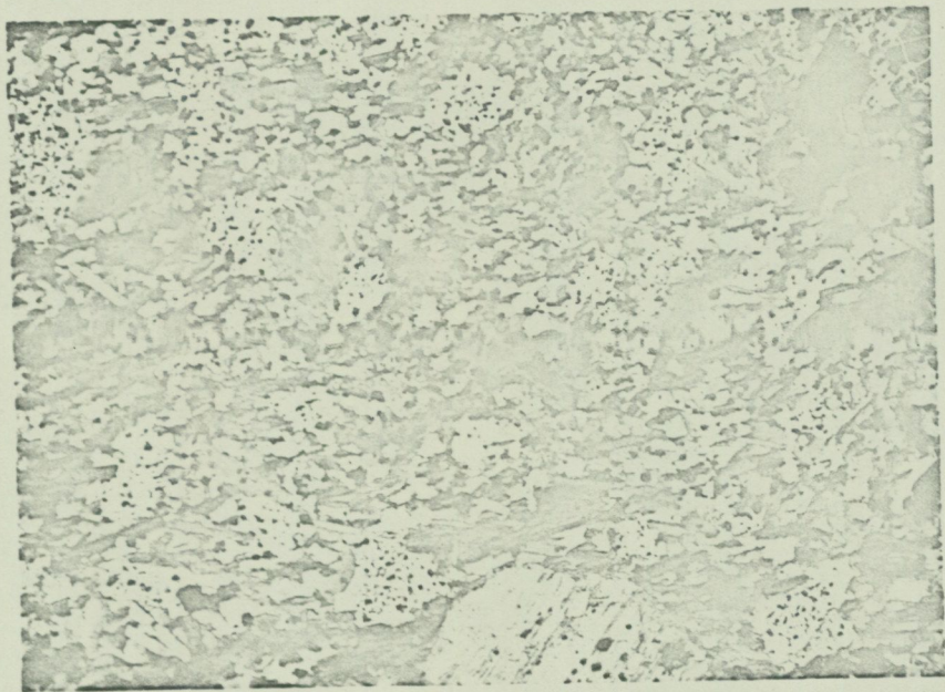
Fig. 34. Basisk leptit. Mikroclin (vita, oregelbundna korn eller aggregat), biotit (grå fjäll) och magnetit (små, svarta korn). I nedre kanten av bilden ett större skapolitkorn. N om Krangruvan. Slipprov. Vanl. ljus, x 38.
