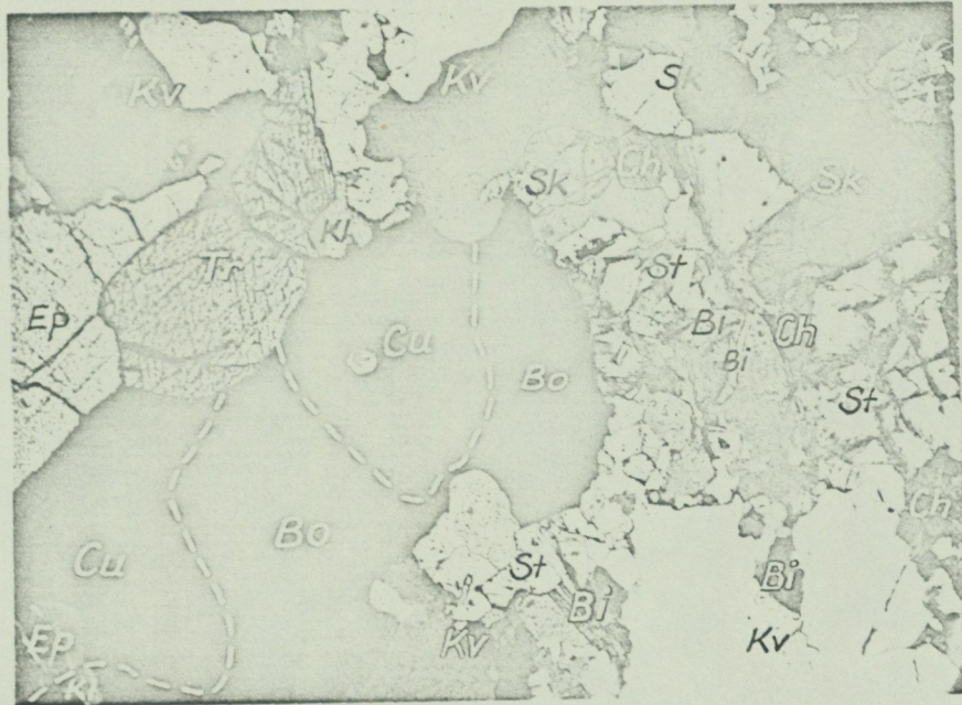
Fig. 47. Kopparmineralisering. Bornit (Bo) och kopparkis (Cu) omges av epidot (Ep), kvarts (Kv), skapolit (Sk), stilbit (St) och tremolit-aktinolit (Tr) jämta små mängder biotit (Bi), chabazit (Ch) och klorit (Kl). Borrhål 58102, 19.9 m. Slipprov. Nic. +, x 29.
