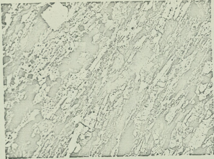
Fig. 33. Basisk leptit. Parallellt aggregat av biotit (mörkgrå) och tremolit-aktinolit (vitgrå) jämte magnetit (svart). Borrhål 58117, 370.3 m. Slipprov. Vanl. ljus, x 38.
