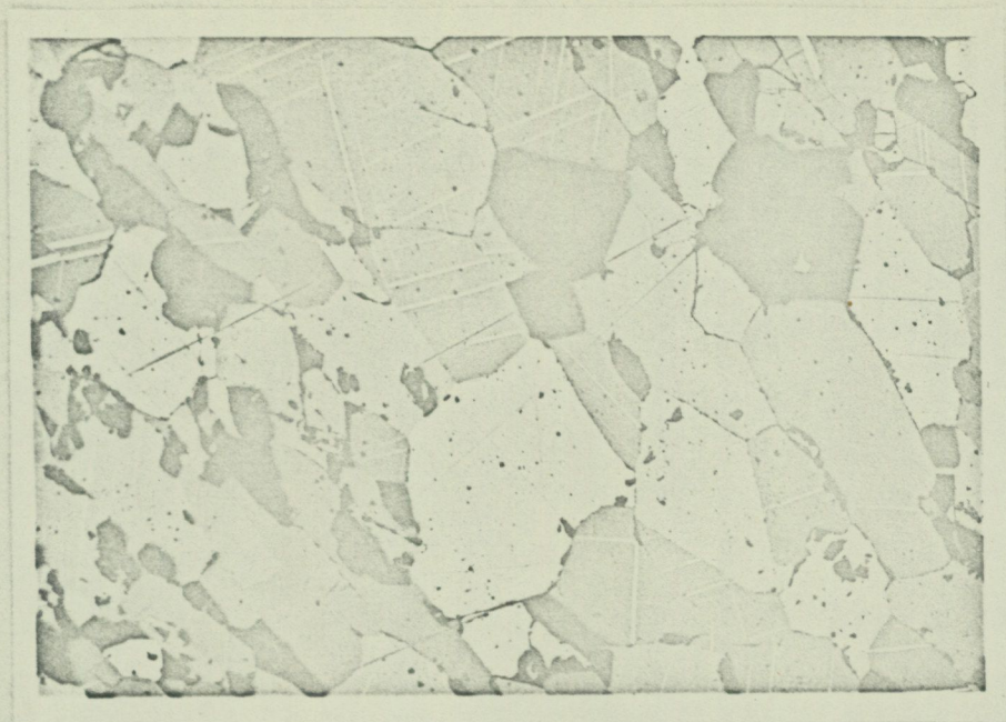
Fig. 14. Finfjällig, parallellstruerad blodsten. Hämatit= vit till mörkgrå. Svarta korn mellan hämatiten utgöres av apatit. Borrhål 58101, 93.8 m. Polerprov. Nic. +, x 77.
