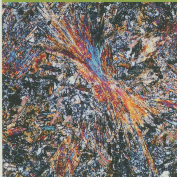
Bilden visar aggregat av amfibol i en omvandlad vulkanisk bergart invid järnmalmerna i Persberg, västra Bergslagen. Mikroskopbild i korspolariserat ljus. Foto: Erik Jonsson/SGU.
