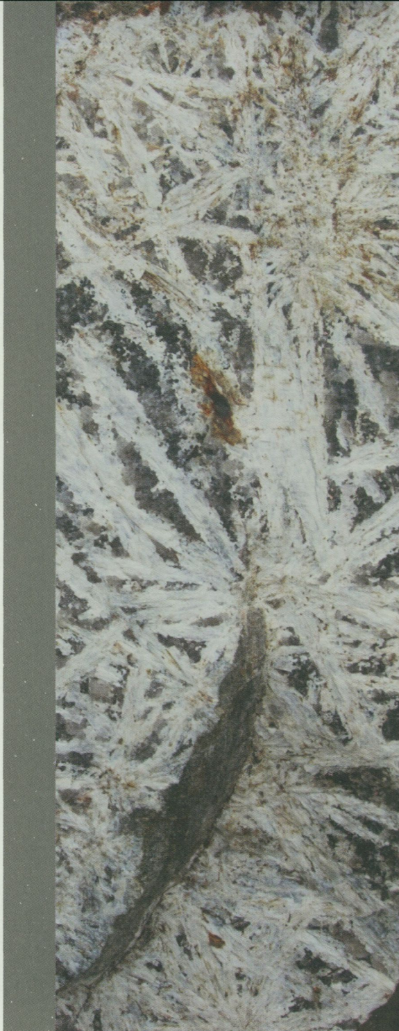
Bilden visar vita, radiella aggregat av skapolit på en spricka genom järnmalm i Sahavaara, Pajala. Foto: Erik Jonsson/SGU.
