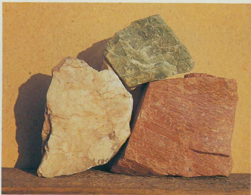
Tre slags fältspat: gulaktigt vit albit eller oligoklas, grön amasonsten och röd mikroklinperthit. Ren fältspat är en viktig industriråvara. P H Lundegårdh 1984.
