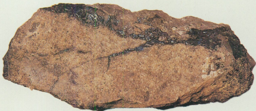
Kopparglans, en högvärdig men mindre vanlig kopparmalm. Fyller sprickor främst i västra Värmland. P H Lundegårdh 1984.
