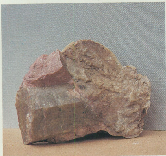
Beryll, till vänster som välutvecklad kristall, till höger i form av aggregat. Det röda mineralet är kalifältspat. Beryll utgör den viktigaste råvaran för framställning av legeringsmetallen beryllium, som är hård och lätt. P H Lundegårdh 1984.
