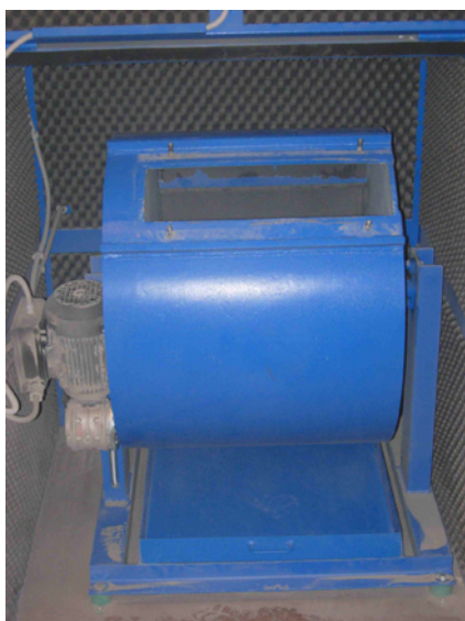
Fig. 10. Los Angeles-trumman är försedd med en lyfttribba. Vid den relativt långsamma rotationen (32 r/min) lyfts 11 stålkulor tillsammans med provmaterialet till trummans topposition var- efter materialet faller fritt och de betydligt större och tyngre stålkulorna krossar stenmaterialet mot trummans botten. LA-värdet definieras som den andel material som är mindre än 1,6 mm efter körning uttryckt som viktprocent av det invägda provet. Ju högre LA-värde desto sämre sprödhetsegenskap. Foto Mattias Göransson, SGU.
