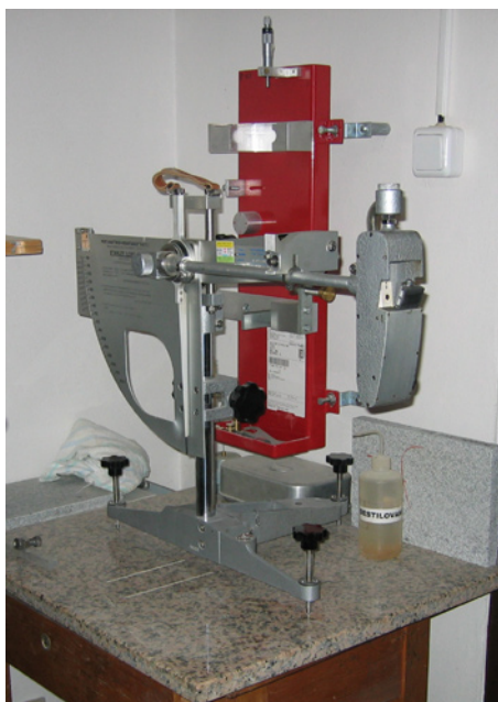
Fig. 13. Mätutrustning för poleringsvärde (PSV), bergmaterial och asfaltlaboratoriet i Horice, Tjeckien. Foto Karl-Johan Loorentz, VTI.
