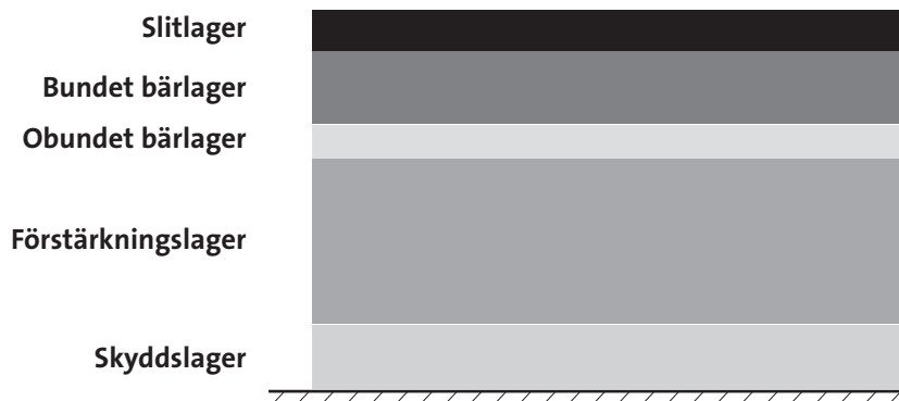
Fig. 1. Principiell uppbyggnad av asfalterad vägöverbyggnad.
