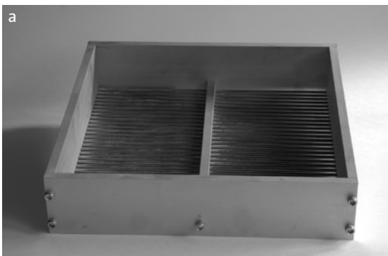
Fig. 12. Spaltsikt för flisighetsindex, FI (a), och specialskjutmått (b) med ett givet längdtjockleksförhållande, SI (3 och 5), för beräkning av kornform. Foto Karl-Erik Alnavik, SGU.
