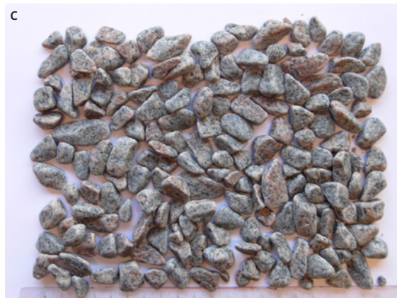
Fig. 3a. Micro-Devaltrumma. Mätproceduren är snarlik den för kulkvarn. På grund av avsaknaden av lyftribbor slits stenmaterialet inte lika hårt som i kulkvarnstrumman. Aggregatfragmenten är i båda metoderna skarpkantade före analys (3b) och mer rundade efter analys (3c). Foto Mattias Göransson, SGU.
