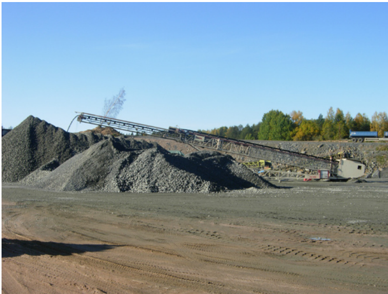
Figur 5. På morgonen programmeras transportören efter de volymer som man avser att transportera; upptill 80 ton material kan transportören klara av på egen hand innan det är dags att flytta den. Foto Mattias Göransson.
