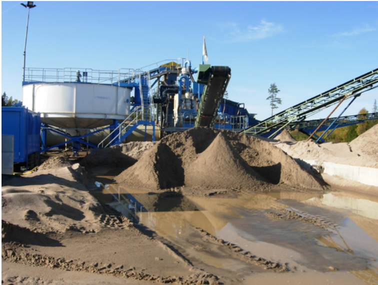
Figur 7. Tvättning av råsand tar bort ler- och andra finpartiklar och fraktionerar slutligen fram lämpliga sorteringar. Foto Åke Berg.
