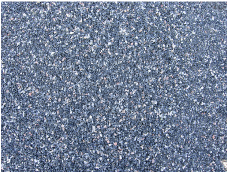
Figur 6. Efter kantnötning i VSI-krossen (a) och tvättning återstår en från berggrunden fraktionerad sortering, tvättad 0–2 mm (b), som kan användas till betong. Foto: Mattias Göransson.
