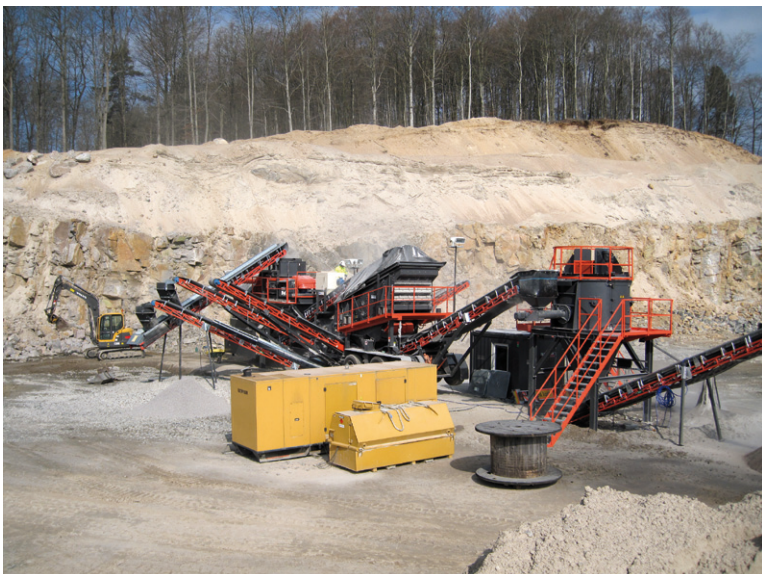
Figur 6. Sandviks mobila krossanläggning i drift i Bröderna Halls bergtäkt vid Finja. Foto: Bengt Olof Tjell, Sandvik.
