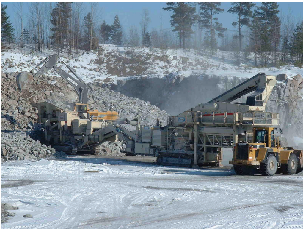
Mobil krossanläggning. Foto: SBMI.
