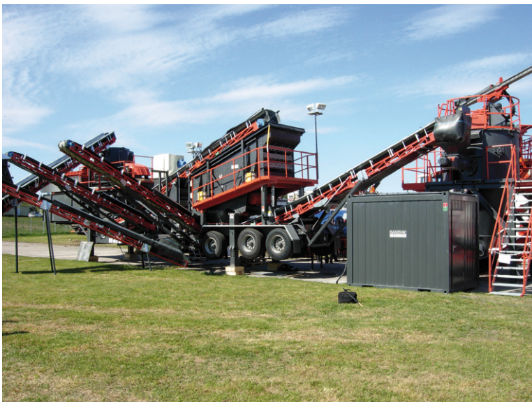
Figur 5. På Maskinexpo 2009 visade Sandvik sin mobila kompletta process för tillverkning av maskinsand. VSI-krossen matas med ett grovt bergmaterial, 0–50 mm, som krossas ner till tre fraktioner (0–4, 4–8 och 8–16 mm). Foto: Mattias Göransson.
