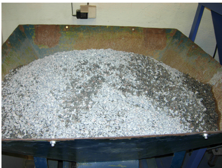
Figur 1. Ett tråg med materialet (4–8 mm) lyfts och förs via en ränna ner i Sandviks VSI-kross för labbverksamhet. Foto: Mattias Göransson.
