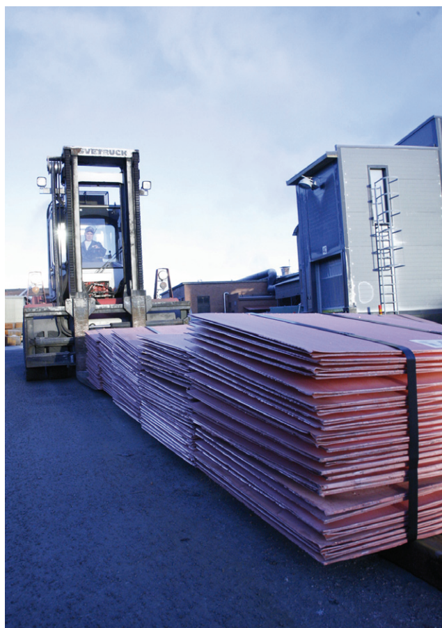
Kopparkatoder. Slutprodukt från smältverket i Rönnskär. Innehåller rent koppar. Foto: Boliden AB.
