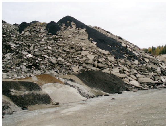
Fig 3. Upplag av asfaltgranulat. Gamla asfaltbeläggningar återvinns i de nya beläggningarna.
