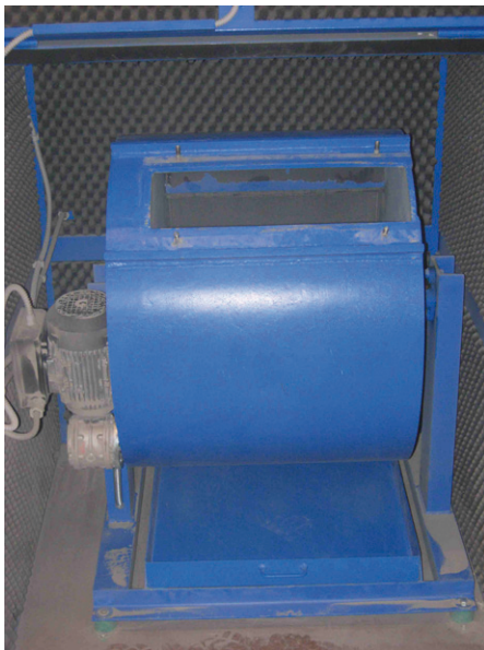
Fig. 4. Los Angeles-trumman är försedd med en lyfttribba. Vid den relativt långsamma rotationen (32 r/min) lyfts 11 stålkulor tillsammans med provmaterialet till trummans topposition varefter materialet faller fritt och de betydligt större och tyngre stålkulorna krossar stenmaterialet mot trummans botten. LA-värdet definieras som den andel material som är mindre än 1,6 mm efter körning uttryckt som viktprocent av det invägda provet. Ju högre LA-värde desto sämre sprödhetsegenskap. Foto: Mattias Göransson, SGU.
