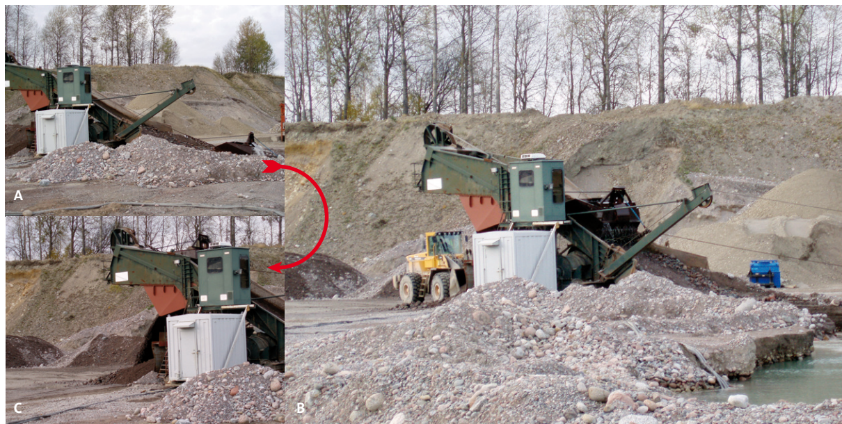
Dragskopan i Wij-täkten. Bild A: Skopan på väg upp ur vattnet. B: Skopan halvvägs uppför rampen. C: Skopan tömmer innehållet på marken. Foto Lars Norlin.
