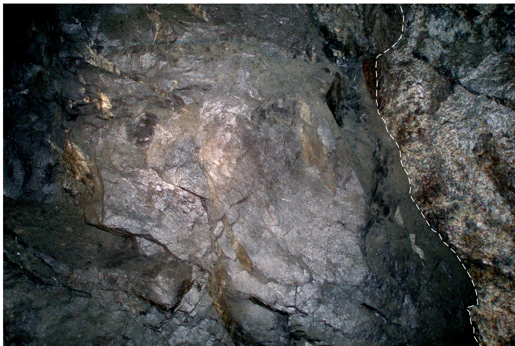
Till vänster malmkropp av magnetit, till höger gråberg, i Kirunagruvan. Foto: Lars Norlin, SGU.
