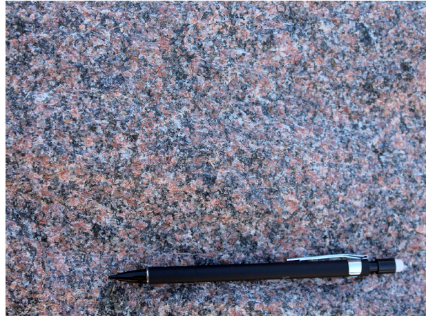
Figur 18. Massformig, medelkornig granit från Stockholmsområdet som har en bra hållfasthet och beständighet, lämplig att använda både för väg- och järnvägsändamål. Foto: Mattias Göransson.
