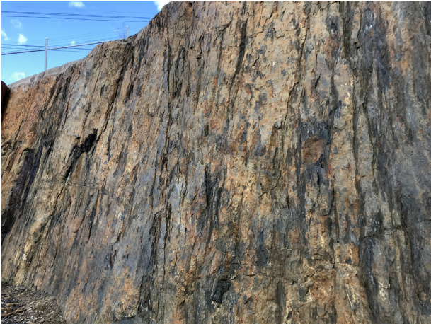
Figur 17. Glimmerrik sedimentär gnejs från Stockholmsområdet. De rostfärgade partierna indikerar oxidering av sulfidmineral. Foto: Mattias Göransson.
