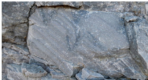
Figur 21. Kambrisk, finkornig Hardebergasandsten som bryts i bergtäkter på Romeleåsen. Eftersom detta bergmaterial uteslutande består av mineralet kvarts är ballasten som produceras hållfast och kan bland annat användas som slitlagersten. Tack vare att materialet är relativt ljust reflekterar även stenen den infallande vägbelysningen bra vilket indirekt innebär lägre kostnader för belysning. Foto: Mattias Göransson.
