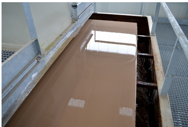
Figur 18. Jämnkornig natursand som rensas, finsorteras via flotation från Baskarp grustäkt, strax norr om Jönköping. Den kvartsrika specialsand som produceras i Baskarp används till flera olika områden. Foto: Peter Åkerhammar, SGU.
