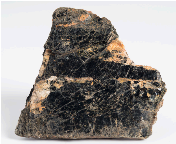
Figur 17. Det vanligaste glimmermineralet biotit. Om en bergart består av mycket glimmermineral försämras ballastens egenskaper för betonggjutning. Foto: SGU.
