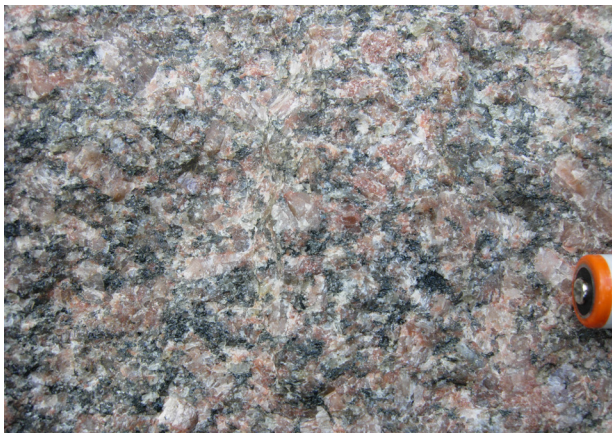
Figur 18. Bergarten granit är ofta ett lämpligt alternativt material till naturgrus för betonganvändning. Bergarten är massformig och då man krossar det splittras stenen sällan i mycket skarpkantade eller flisiga korn, vilket ökar användningen av materialet till betong. Foto: SGU.
