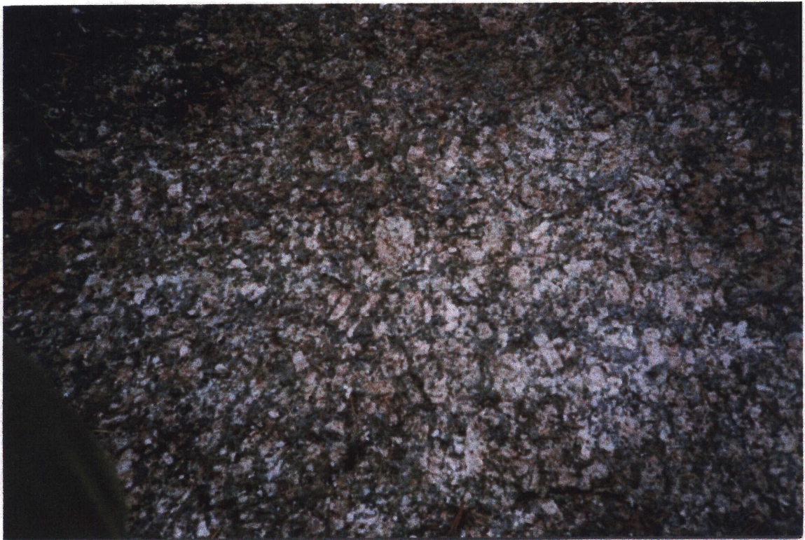
Foto 2: Mineralkornens former är varierande, ovala, tavelformiga och rundade förekommer.
