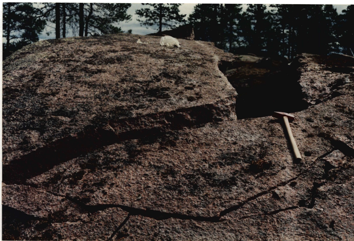
Ytsprickigheten är låg i primärblocket (vänstra delen av bilden).
