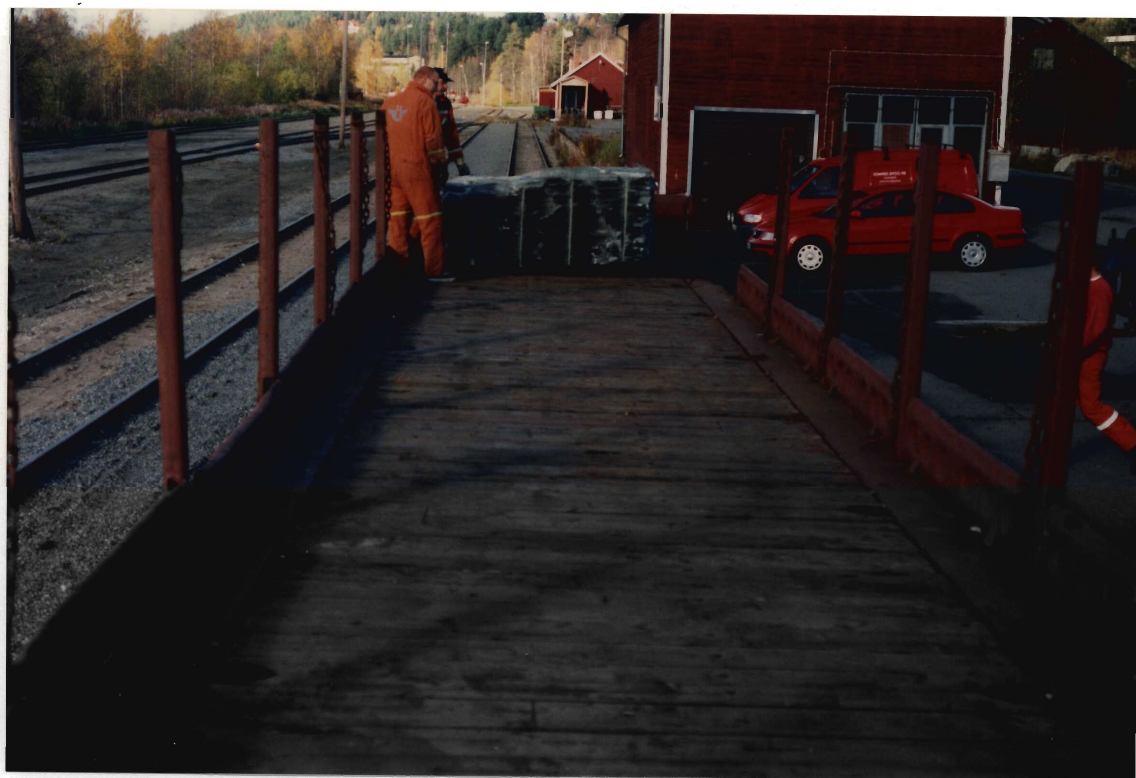
Blocket ligger nu på vagnen, men måste justeras i sidled. Observera att det finns två rader med öglor i golvet längs vagnen. Dessa öglor var idealiska att fästa spännbanden i. Vagn 2 var något annorlunda och betydligt sämre att lasta. Där saknades dessa öglor.
