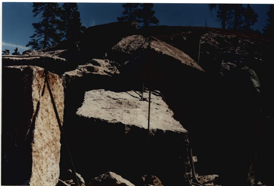
Sönderdelningen av primärblocket och blockfriseringen inne i sitt slutskede.
