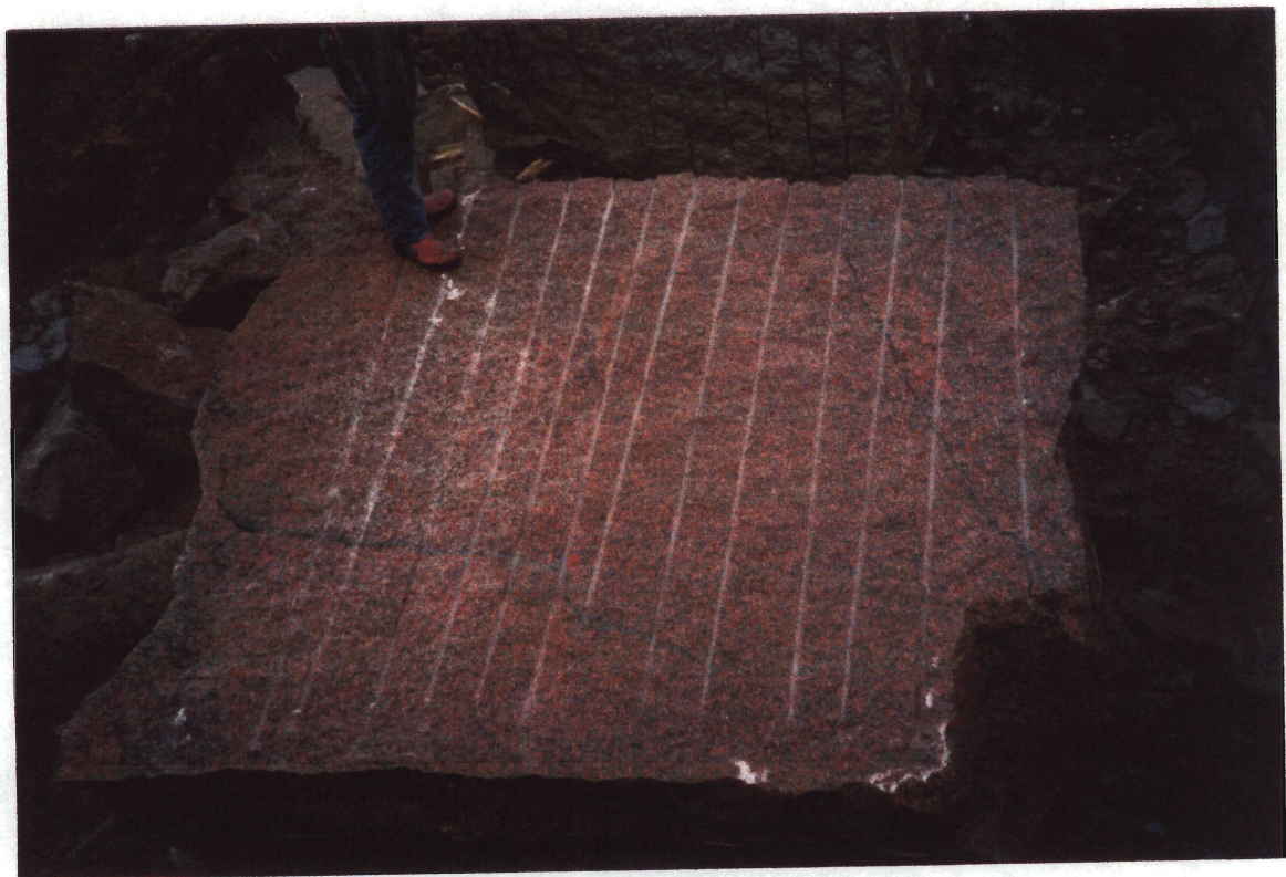
Foto 4 och 5: Graniten i den östliga hällen varierar ibland ganska mycket i inslag av mörka mineral, biotit och hornblände. I öppnat berg observeras också orientering av mineralogin.
