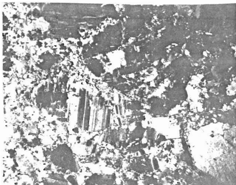
Foto 8. L73:33 Kataklastisk gnejsgranit. Något mer nedbruten än L73:12. Observera hur en stor plagioklaskristall bryts sönder i ungefär mitten av bilden. Ofta böjs tvillinglamellerna under denna process. Det mörkare området i övre högra hörnet utgörs av större mikroklinperthiter som granuleras och bryts upp.
