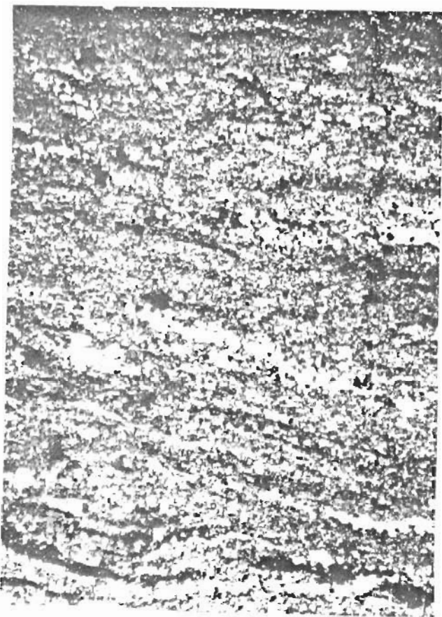
Foto 11. Gnejsgranitmylonit, L73:55, från Mellanskällans undre myloniter. De stora kristallerna har nu nästan alla målts ner till mer eller mindre oidentifierbarhet. Bandningen är mylonitisk.
