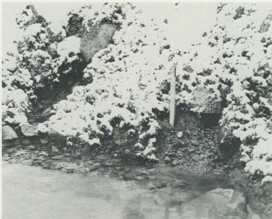
Fig. 4. Utströmning av grundvatten ur tjälad schaktvägg i morän. Vattnet strömmar i linser och skikt av sorterat sandigt-grusigt material i en f. ö. tät moränmassa; det är sålunda fråga om verkliga vattenådror. (foto G. Knutsson 1965)
