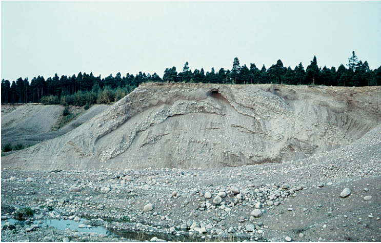
Fig. 11. Skärning genom Nybroåsen i grustaget öster om f.d. Vassmolösa station. Bilden visar växlande lager av väl sorterat stenigt grus och väl sorterad grusig sand med mycket god vattengenomsläpplighet. Grundvattenytan är blottlagd i den främre delen av bilden. I den östligaste delen av grustaget påträffades senare en plint av hårt packad, tät sandig morän med hög halt av enbart sandstenar, dvs. en lokalmorän av sandsten. Plinten låg inbäddad i väl sorterat grus (foto G. Knutsson 1960).
