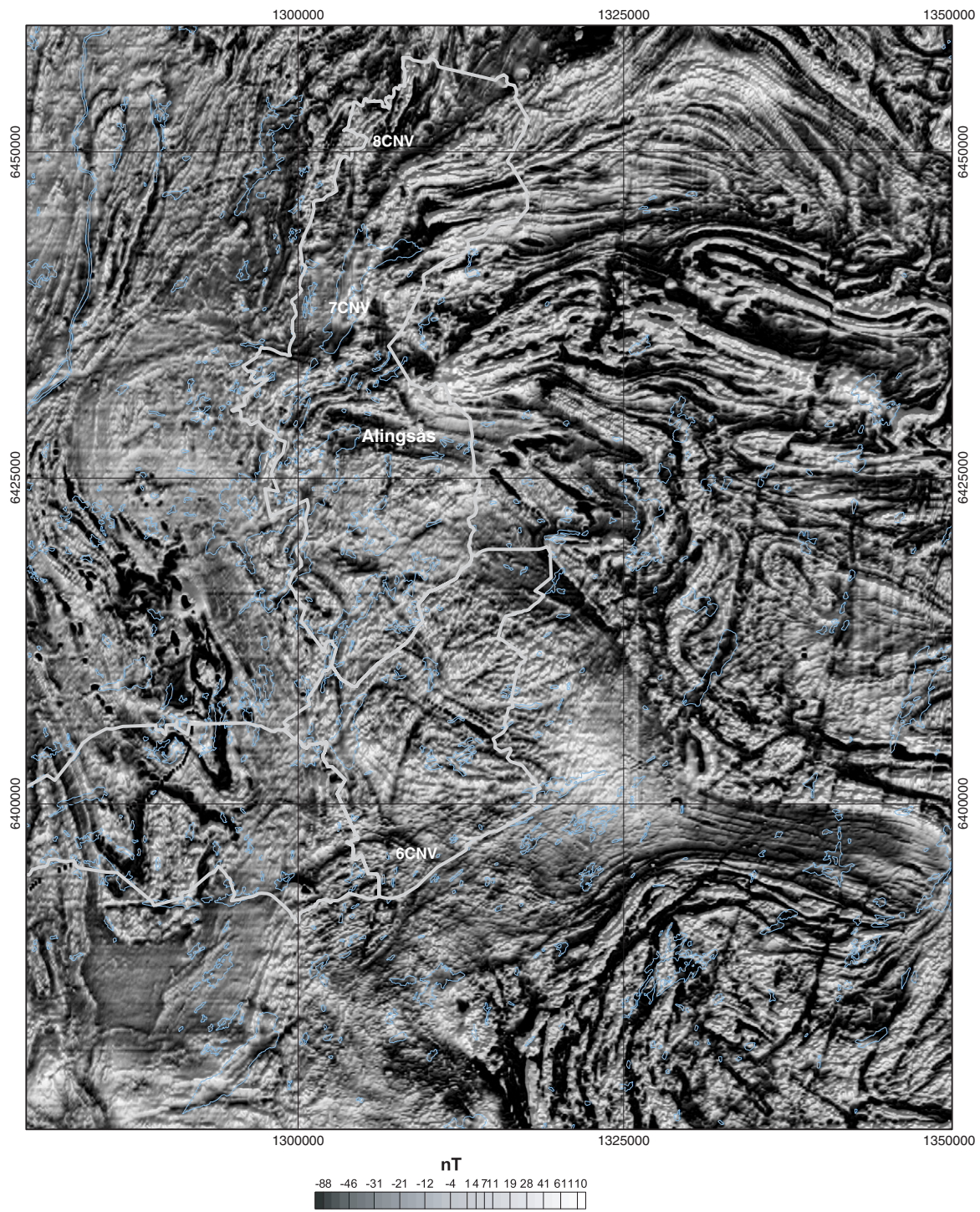
Fig. 10. Magnetisk anomalikarta där långvågiga anomalier är avlägsnade.
