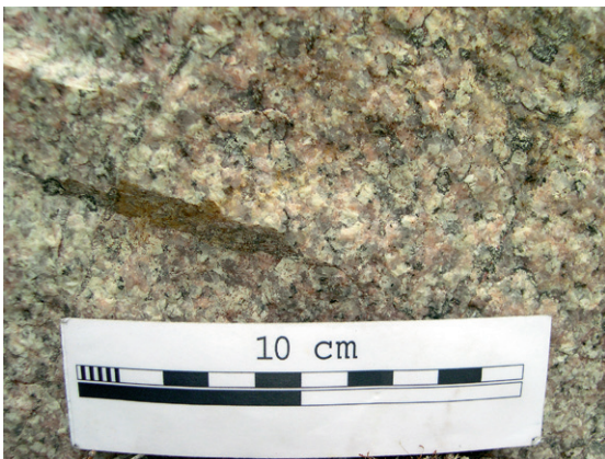
Fig. 9. Pegmatitgranit (GP). Vit till blekt rosa, muskovitförande, medelkornig och massformig (6724238/1469230), koordinater i rikets nät.
