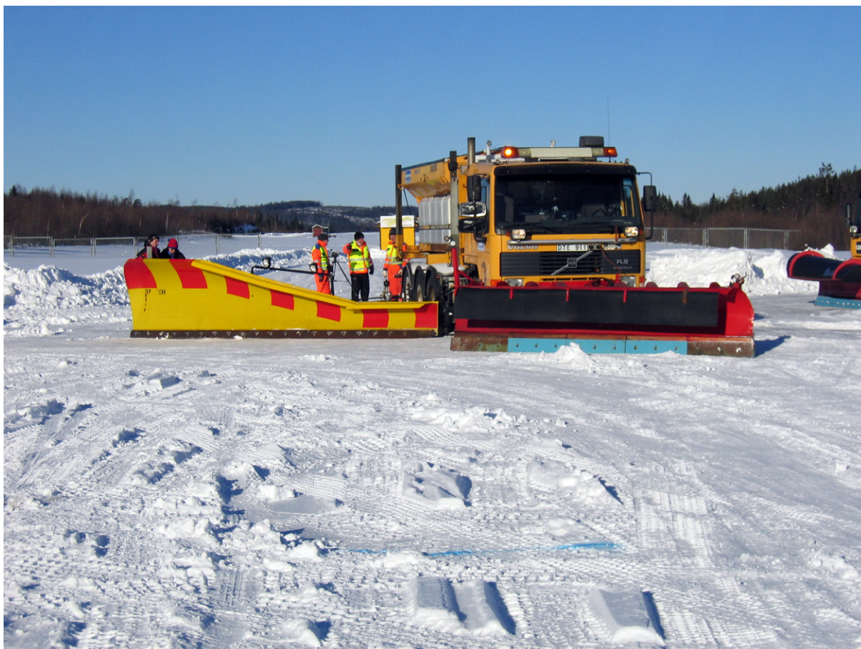
För att ny teknik, som syftar till att både minska saltanvändningen och risken för olyckor, ska fungera krävs god vägstandard. En jämn vägyta krävs för nya snöplogar. I spåriga vägbanor ligger snö och is kvar i spåren efter plogning, väglaget blir halt och behovet av salt kvarstår. För att arbetet med att minimera saltgivorna ska ge resultat krävs därför tillräckliga resurser för vägunderhåll, bland annat för beläggning. Tendensen är att eftersläpningen i underhåll ökar. Långsiktigt kan det vara negativt för grundvattnet. Foto: Vägverket produktion, Bollnäs.
