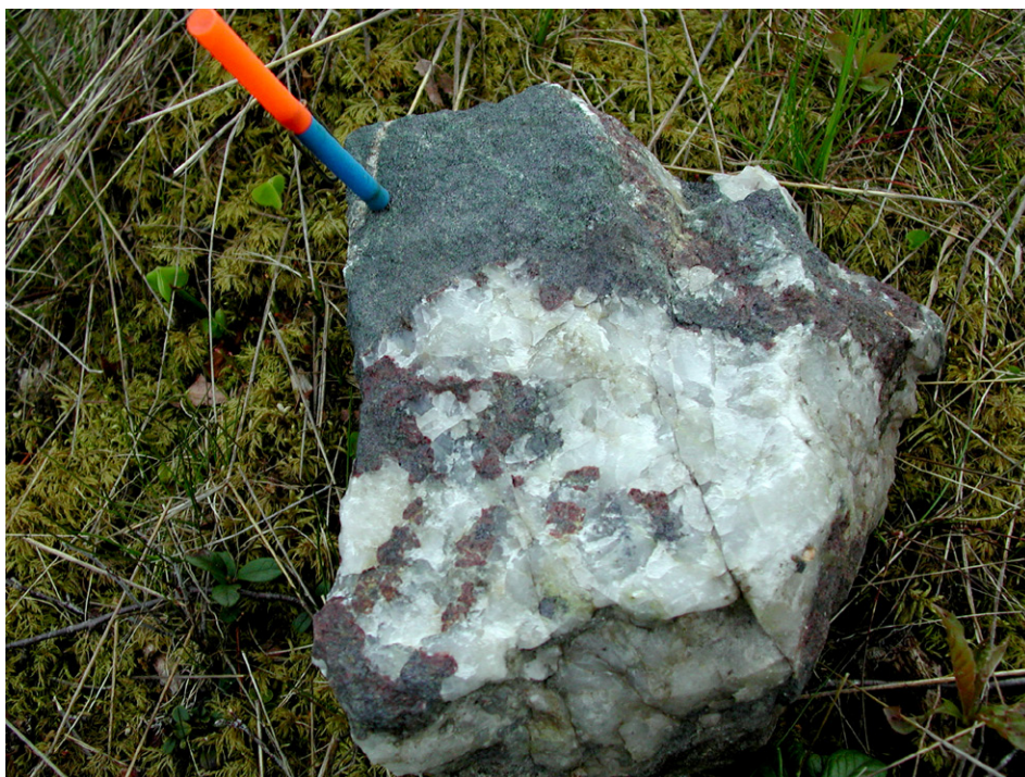
Fig. 20. Malmen i Hundtjärnsgruvan 1 är en skarnrik svartmalm. Foto: Nils-Gunnar Wik.
