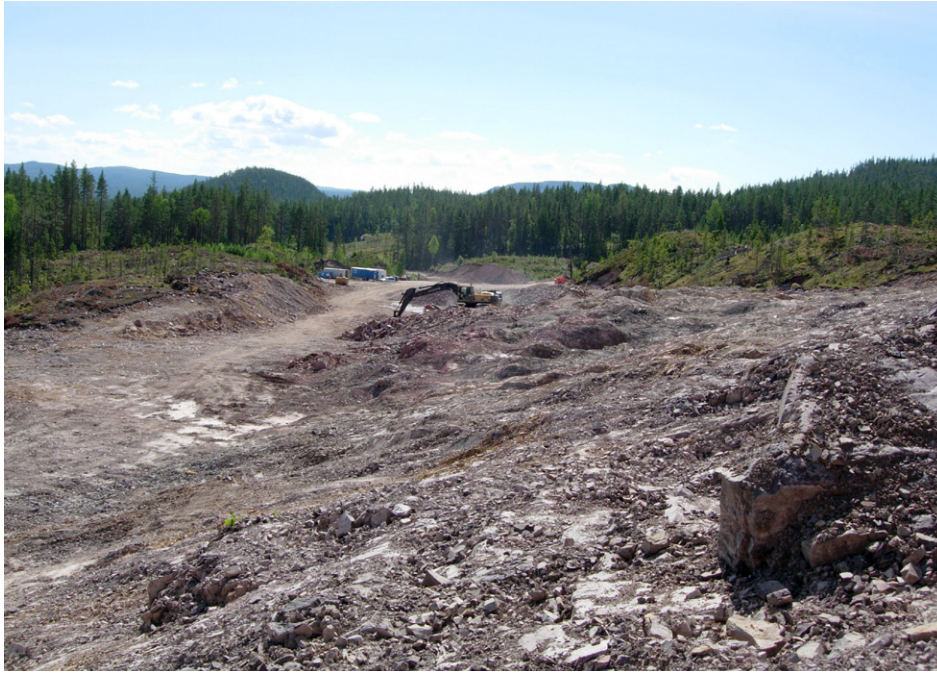
Fig. 82. Bergtäkten vid Sildakorvamägg öppnades sommaren 2004 i en röd till mörkröd porfyr för krossbergsproduktion till väg- och dammbyggnad m.m. Foto: Arne Sundberg.
