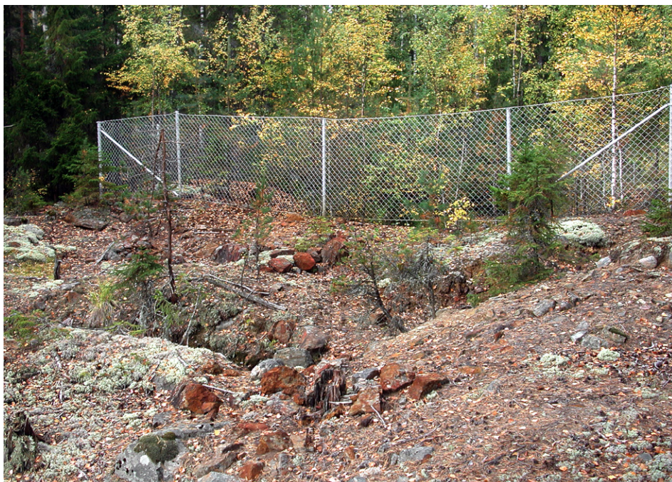
Fig. 70. Johannisbergs koppargruva, här fotograferad mot väster, är öppnad i en kraftigt rostbrunfärgad, sulfid-mineraliserad bergart. Foto: Nils-Gunnar Wik.
