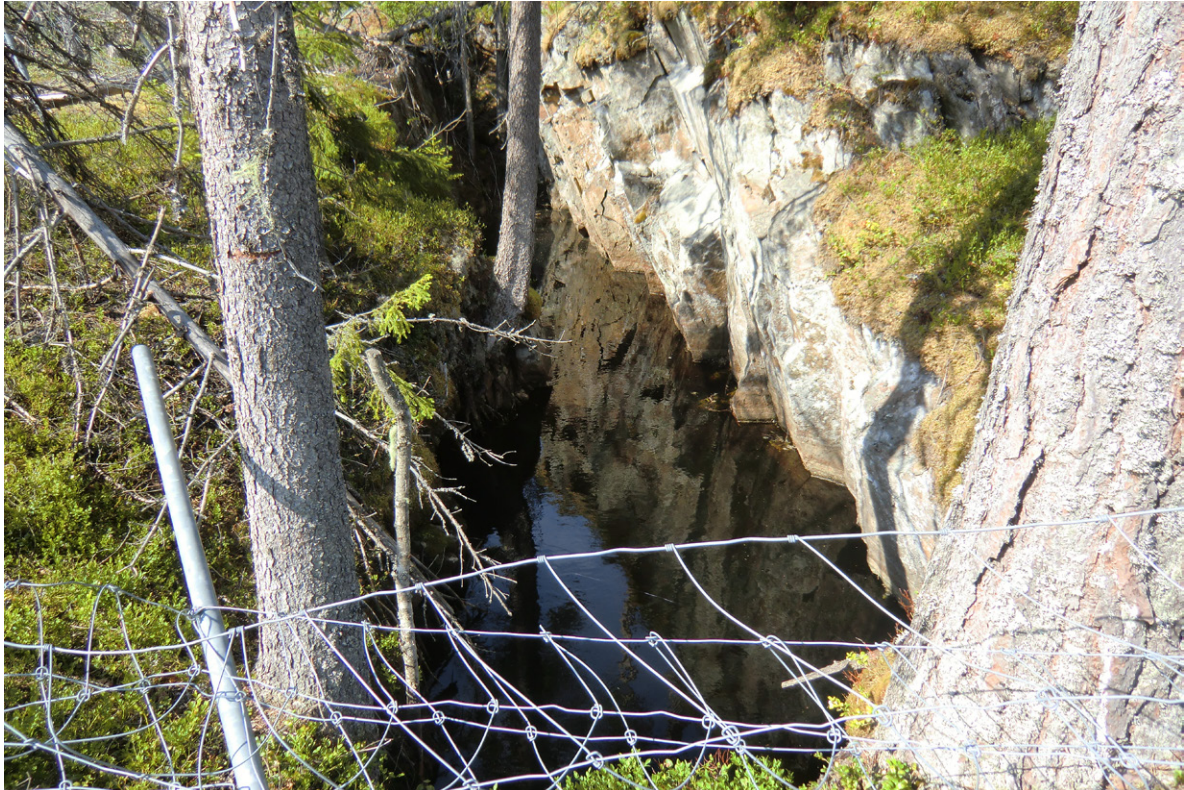
Vargbergsgruvan 11 med trasig inhägnad, är bruten donlägigt, brant mot nordöst. Moderate dip of the mineralisation at the Vargbergsgruvan 11 mine.
