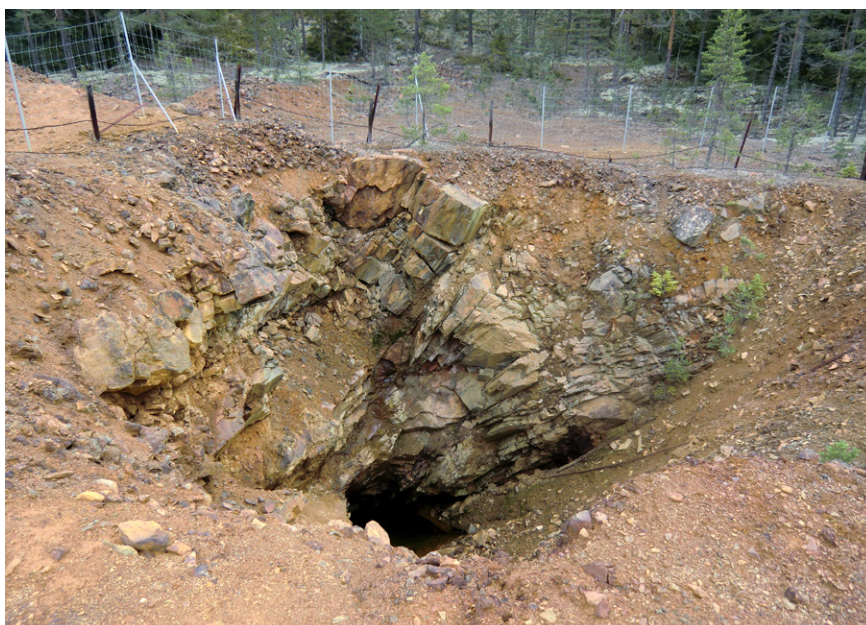
Gruvöppning med donlägig brytning mot nordöst till ca 100 m djup.
