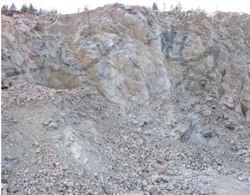
Granats berg, Källbäcken. Krossbergstäkt i metagranit till granitisk gnejs. Aggregate rock quarry in metagranite to granitic gneiss.
