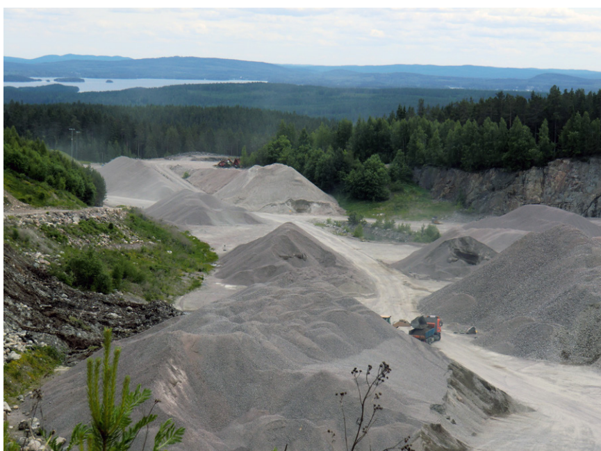
Krossat berg vid Falukrossen i olika fraktioner för väg- och husbyggnad. I bakgrunden syns sjön Runn.
