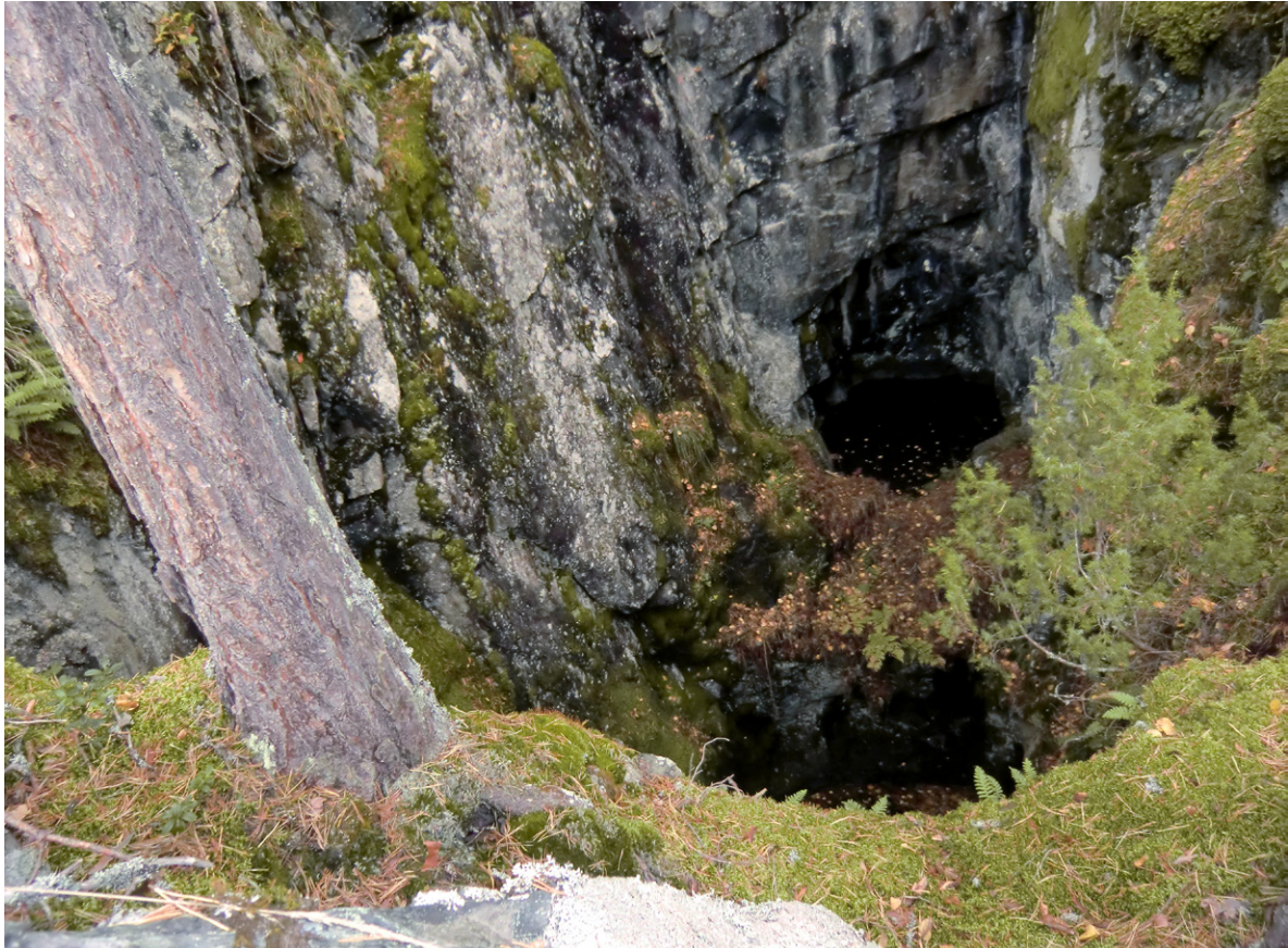
Predikostolsgruvan 1 (alt. Sommarbergsgruvan 5) med lodräta, oinhägnade gruvväggar har sannolikt brutits genom tillmakning. The vertical walls of Predikostolsgruvan 1 mine were probably made by fire setting technique.
