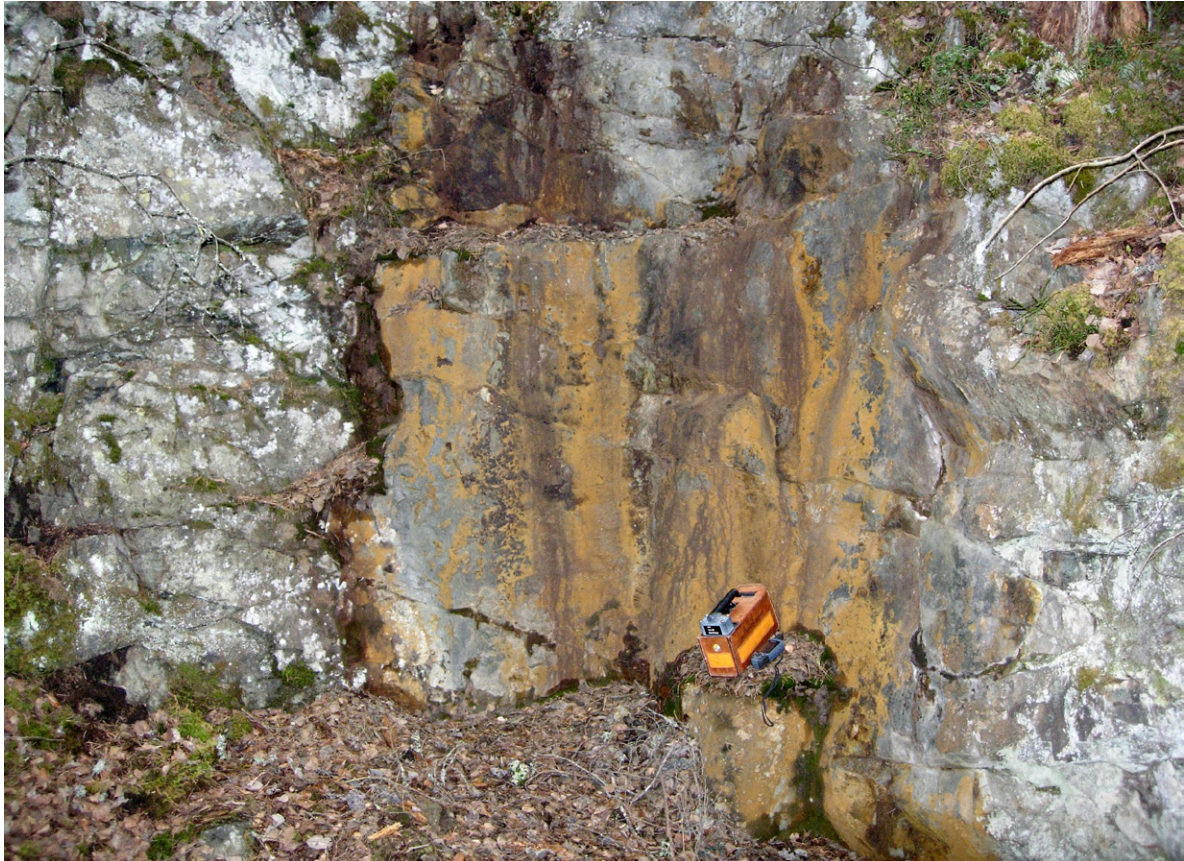
Rostvittrad, vertikalt stupande sulfidmineralisering med något scheelit i Gahns skärpning 2. Weathered, scheelite-bearing sulphide mineralisation in the Gahns skärpning 2 prospect.
