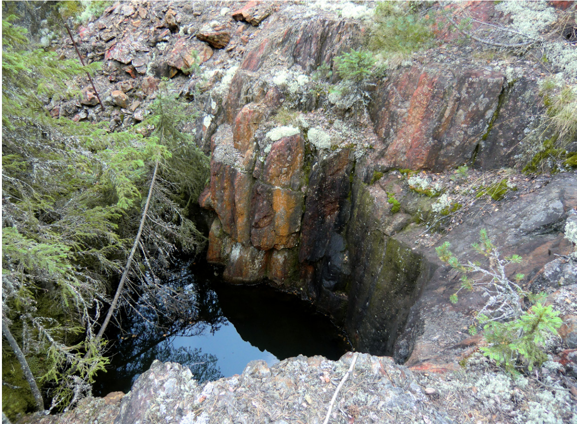
Den vertikalt stupande mineraliseringen i gruvöppningen ca 6 m söder om Flobergsgruvan 1 är ca 1 m bred. Circa 1 m wide, vertically dipping mineralisation by the Flobergsgruvan 1 mine.
