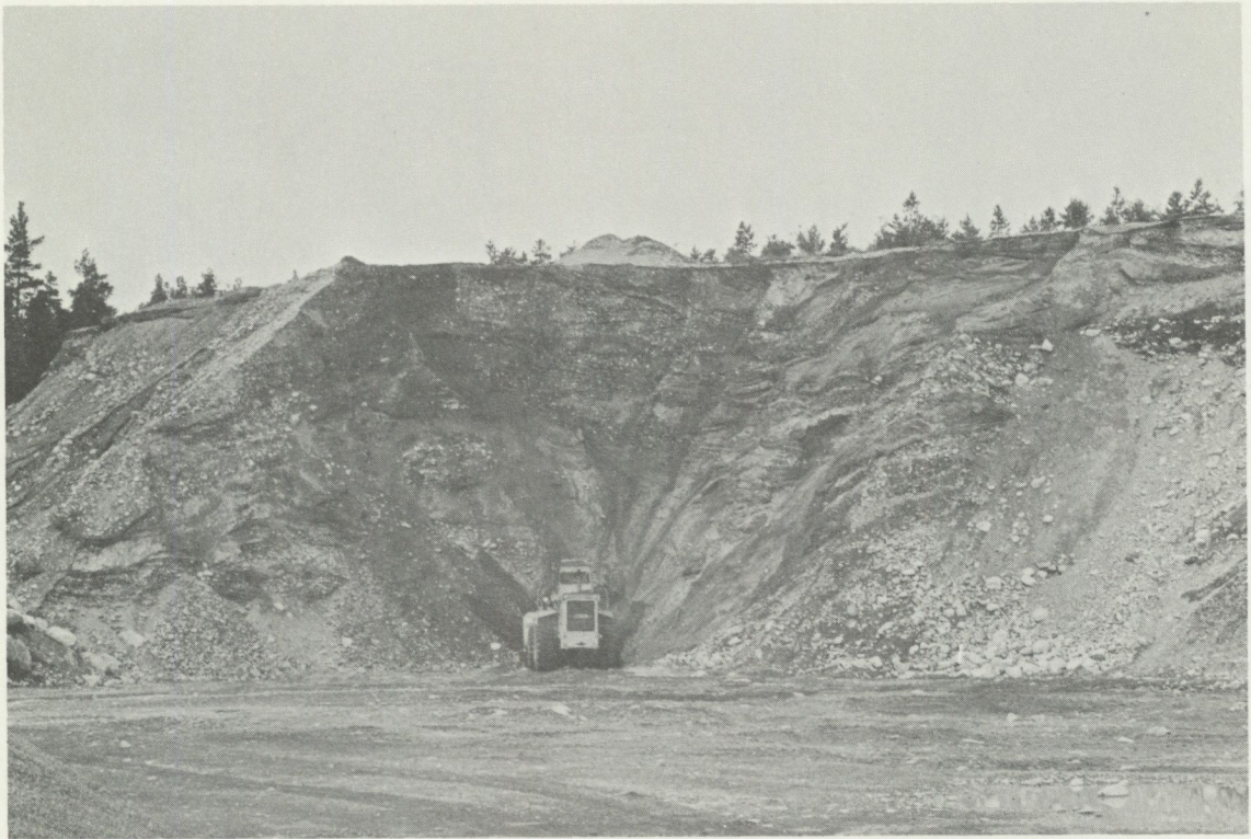
Fig. 8 Skärning i platå med grov materialsammansättning i förekomst G 11 söder om åsnätet i Igersdela. Skärningsväggen är ca 15 m hög. Den kvarvarande volymen är drygt 2 milj. \text{m}^3 (foto L. Rudmark 1978)
