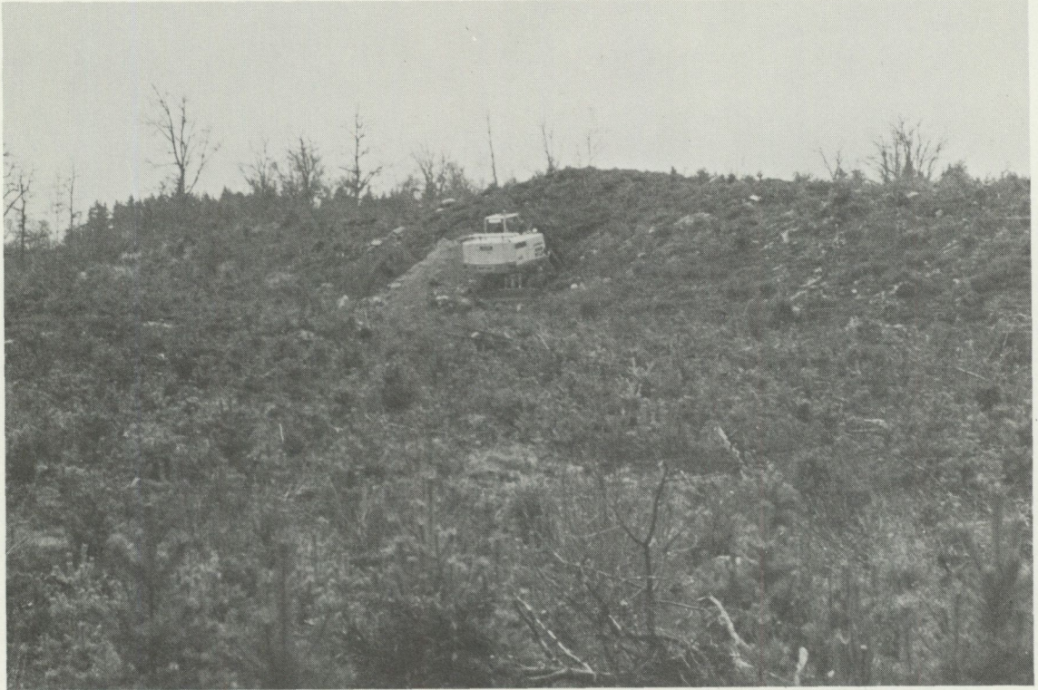
Fig. 23 Provschaktning i rygg av porfymorän med normalblockig yta. Förekomst M 45 Högelycke (foto S. Ekberg 1978)
