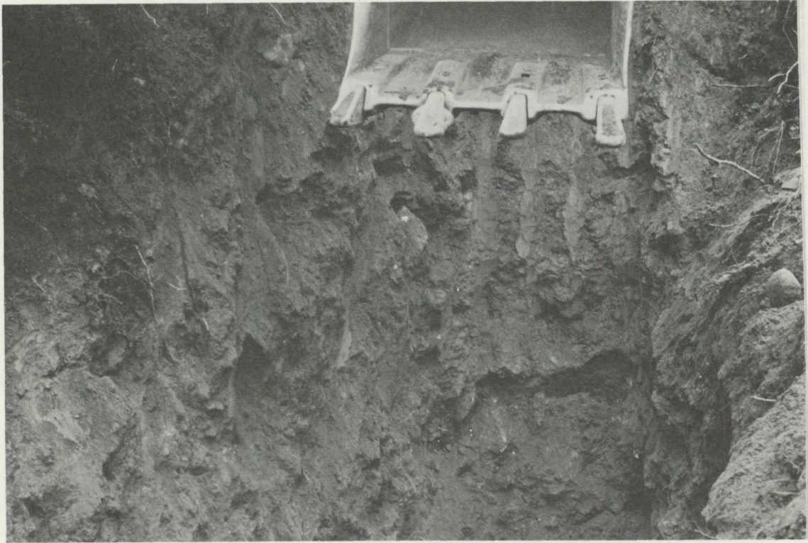
Fig. 19 Normal (sandig-moig) morän med låg-måttlig stenhalt (ca 15%) vid förekomst M 12 öster om Otteskruv (foto S. Ekberg 1978)
