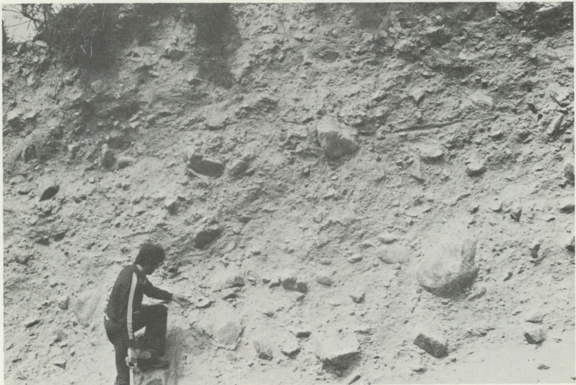
Fig. 22 Normal-grov morän med måttlig sten- och blockhalt. Förekomst M 9 Toresbo, norra tälkten (foto L. Rudmark 1979)
