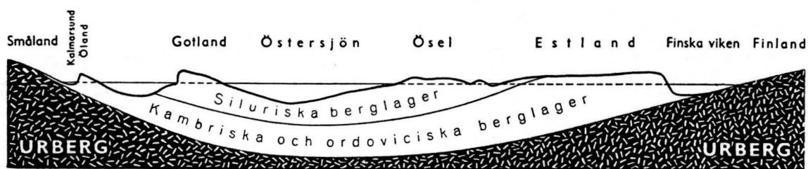
Fig. 28. Schematisk profil genom Östersjöbäckenet från Kalmarsund till Finska viken. Efter von Post (1940).
