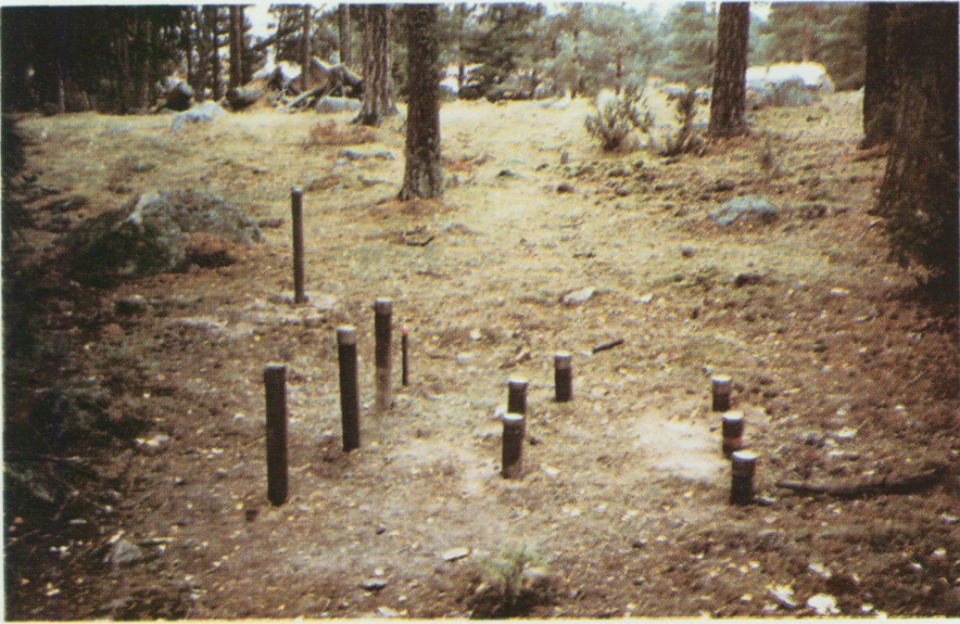
BÖRJE Mätplatsen med färdig- monterade skyddsror.
