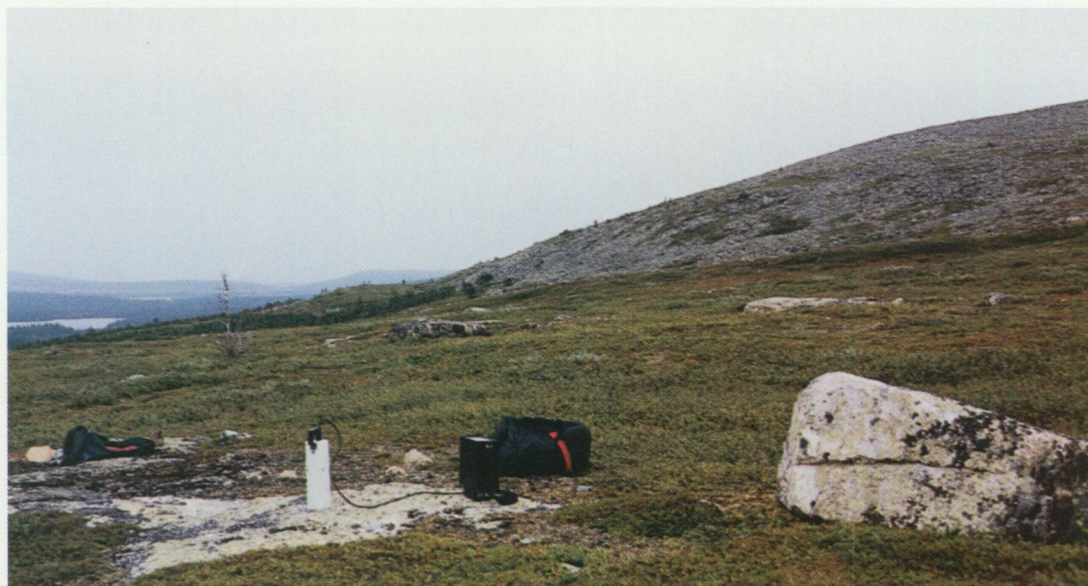
Fig. 3. Mätning av strålningen på Avvakkotunturi, ca 650 m.ö.h. (28K Gällivare NV) med spektrometer GS320. Bergarten är granit av Linatyp.
