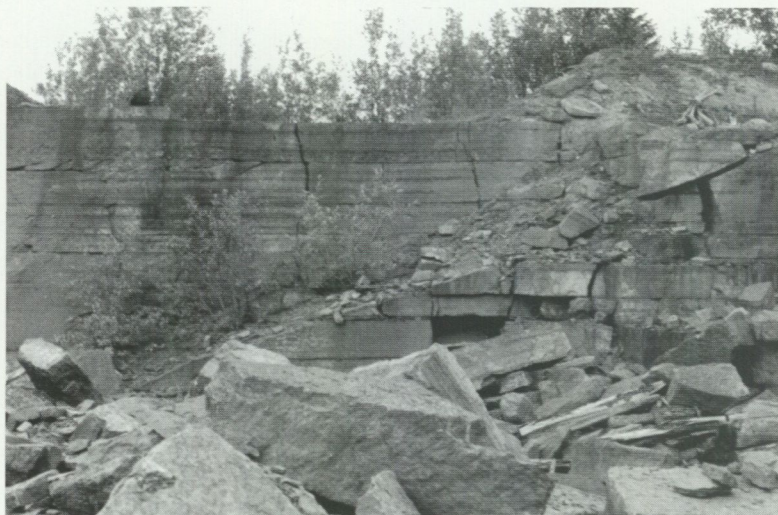
Fig. 2. Det rombiska mönster som bildas av rörelseplanen i en vertikal bergyta. Stora Rödstensbrottets norra vägg. Även ett mera storskaligt överskjutningsplan är synligt närmare förgrunden.
