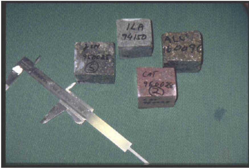
Figur 6. Exempel på kuber som sågats ur insamlade bergartsprov. Sidlängderna varierar i intervallet 20 – 50 mm.
