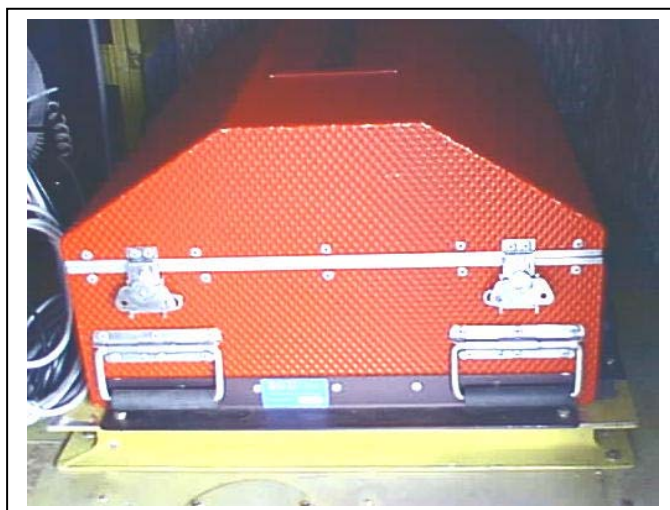
NaI kristallen som används som detektor. Detektorns vikt är ca 130 kg.
