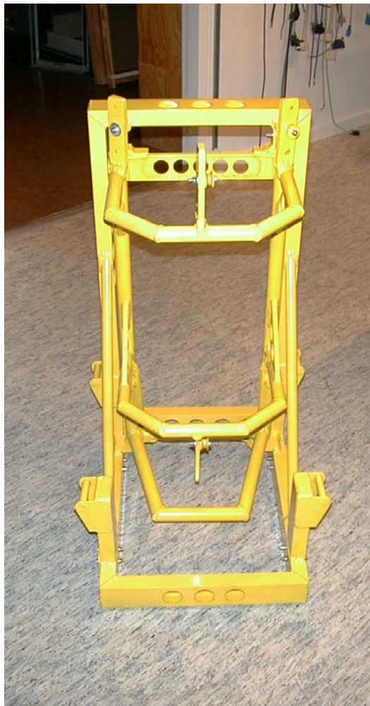
Racken för 100% HPGe detektor.
