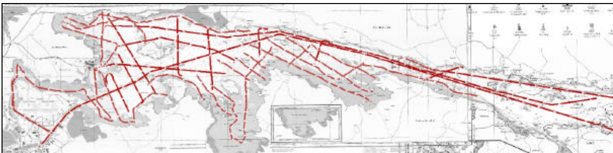
Figur 1. Bråviken med mätlinjerna inlagda. Mätningar är utförda med SGUs undersökningsfartyg Ocean Surveyor och i grunda områden med en grundgående arbetsbåt.
