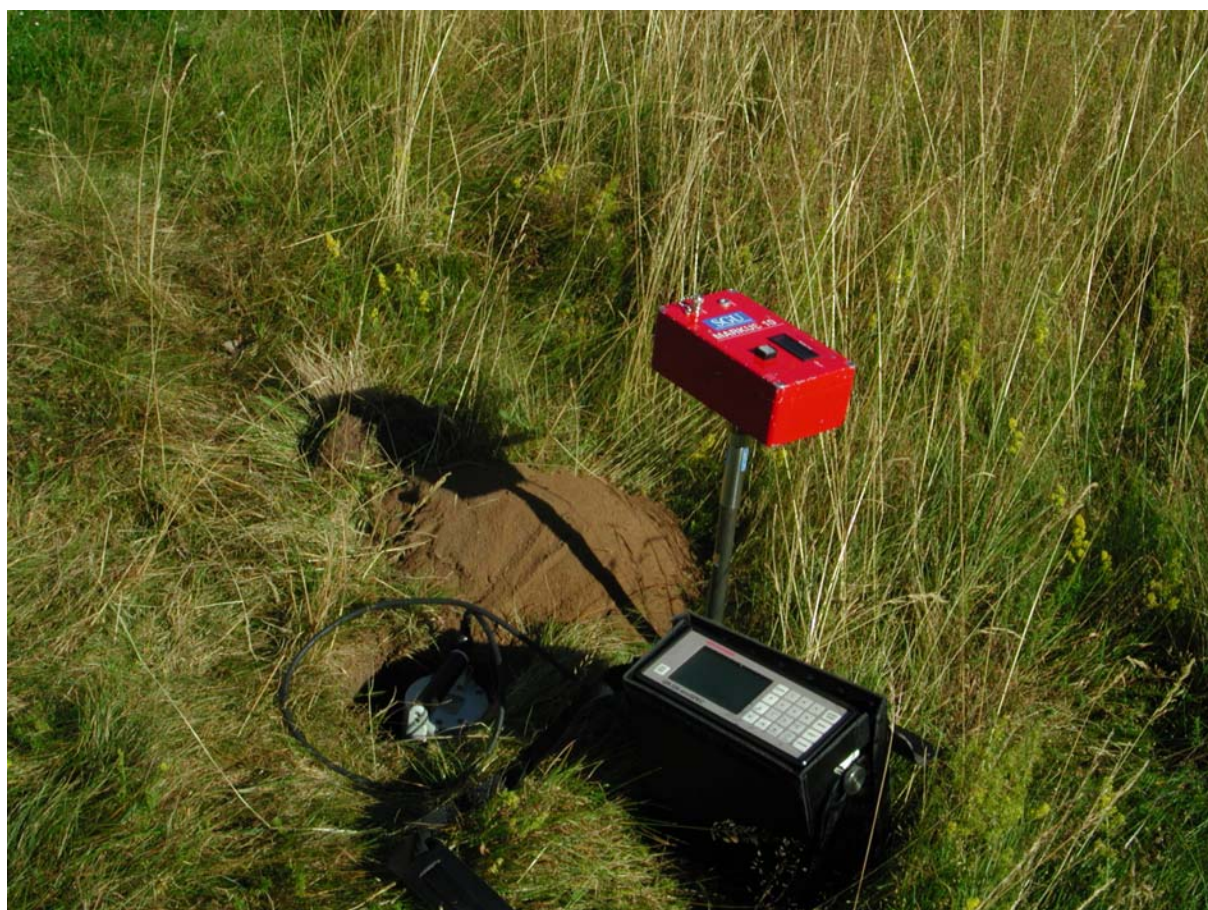
Figur 14. Framför emanometern mäter gammaspektrometern innehållet av U, Th och K-40 i jorden. Emanometern på bilden är av typ Markus 10.
