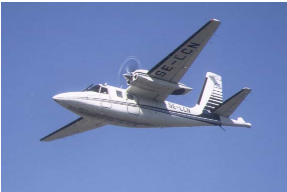
Figur 10. Flyggeofysiska mätningar utförs numera på ca 60 meters höjd över markytan och med ett flyglinjeavstånd av ca 200 meter. Hittills har ca 75 % av landets yta kartlagts.
