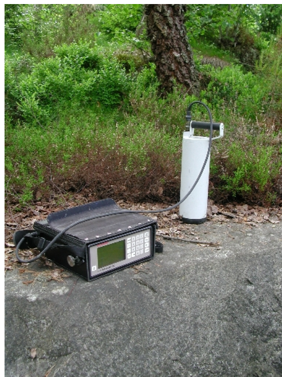
Figur 13. Mätning med gammaspektrometer. Gammaspektrometern ger en detaljerad bild av gammastrålningen från de olika isotoperna.
