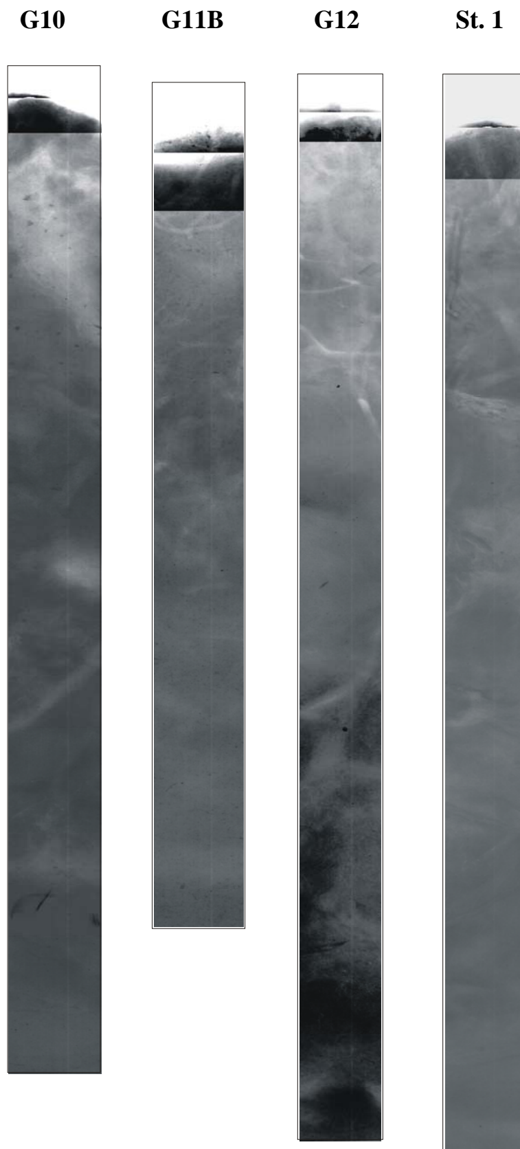
Fig. 4. Radiografiska bilder av sedimentkärnor från provtagningsomgång 2002-08-27. Över sedimentkärnorna ligger bottenvatten. Ju mörkare sediment ju högre densitet. Den skarpa gränsen i kärnornas övre del är en effekt av ändrad exponeringstid.
