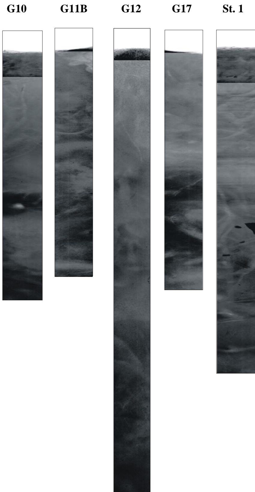
Fig. 4. Radiografiska bilder av sedimentkärnor från provtagningsomgång 2003-02-27. Över sedimentkärnorna ligger bottenvatten. Ju mörkare sediment ju högre densitet. Den skarpa gränsen i kärnornas övre del är en effekt av ändrad exponeringstid.
