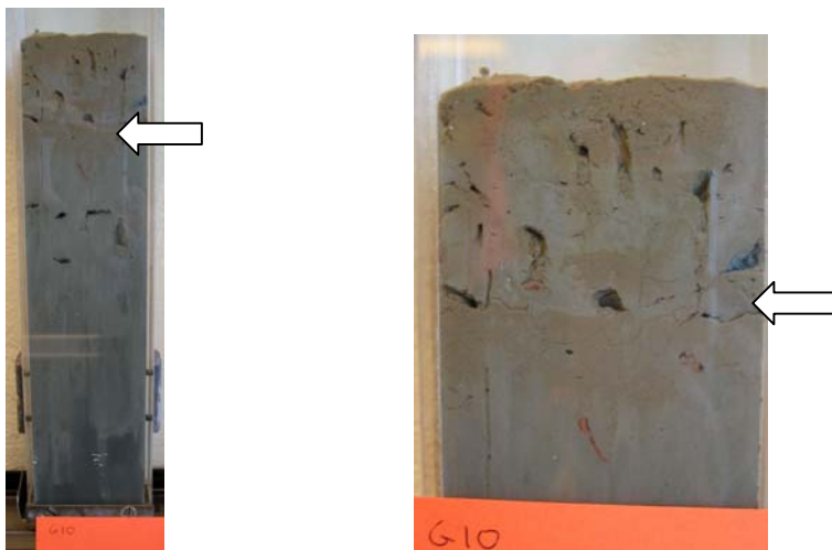
Fig. 4. Station G10, provtagningsomgång 2004-04-16, utvisande motsvarande sedimentlagerföljd som i fig. 3, men här redovisad från kärnan avsedd för röntgen (t.v.) samt detalj från denna över de översta 8 cm (t.h.). Pilarna redovisar sedimentgränsen vid 4 cm. Ovanför 4 cm ses en grå lera med porer och havsborstmaskgångar samt omblandat brunt ytskikt. Foto: F. Klingberg.
