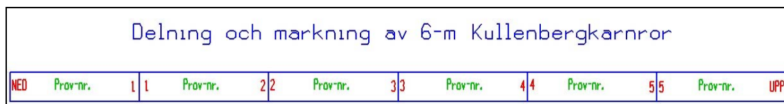
Fig. 5. Delning och märkning av kolvlodskärnor.
