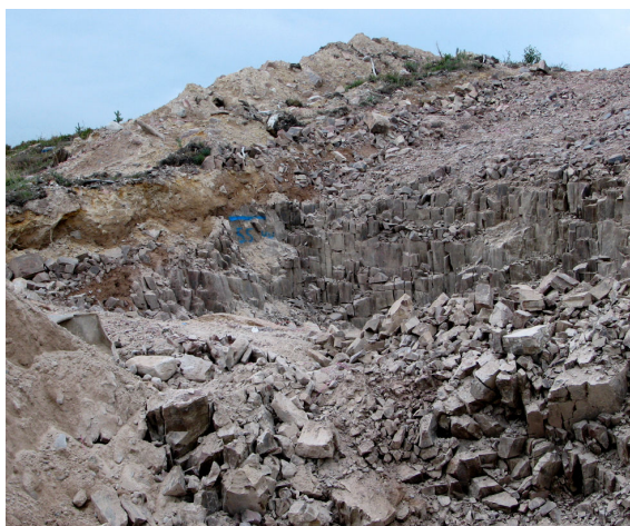
Fig. 8. Tåktens nordvästra hörn med pelarformigt uppsprucken porfyr, under 0,5-1 m morän.
