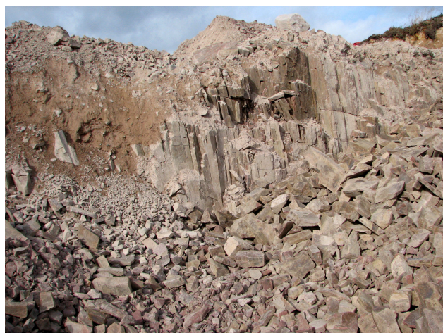
Fig. 9. Vid lättat tryck, efter urgrävning, vidgas sprickorna och pelarna faller sönder till rektangulära stenar.
