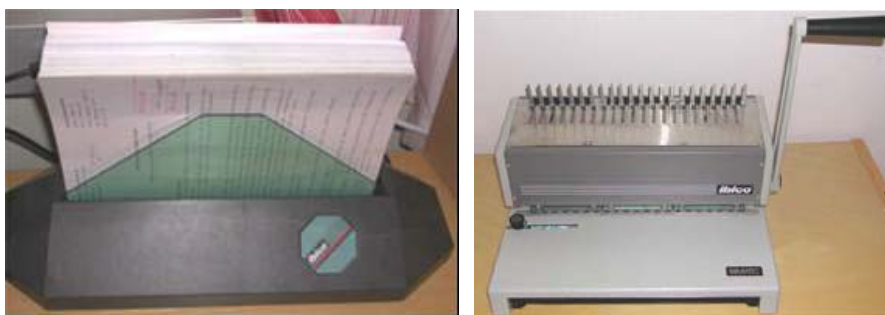
Figur 4. Inbindare (vänster) som används till att ta isär en rapport innan ADF-skanning. Till höger en öppnare för spiralinbindning.
