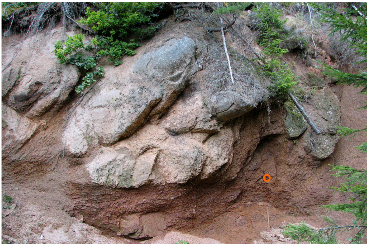
Fig. 7, lokal 1. Sydvästra väggen i skärningen, sedd mot väster med sydostligt stupande, spolformade klotblock. Prov för XRD-analys är taget ca 5 m under markytan vid den röda ringen i bildens nedre högra halva. Foto, Jan-Olov Svedlund.
