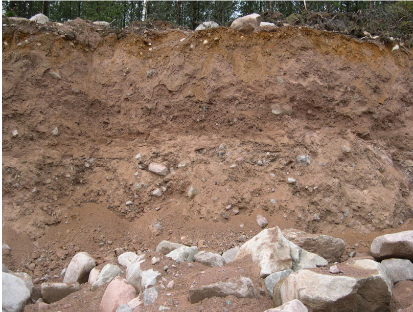
Figur 1. I tåkten vid Nödjuhult ca 10 km öster om Eksjö konstaterades två olika moränbäddar åtskilda av ett tunt sandskikt. Allra överst fanns en tunn (0-0.5 m) och starkt moig enhet med enstaka stenar som möjligen var lätt vindpolerade.
