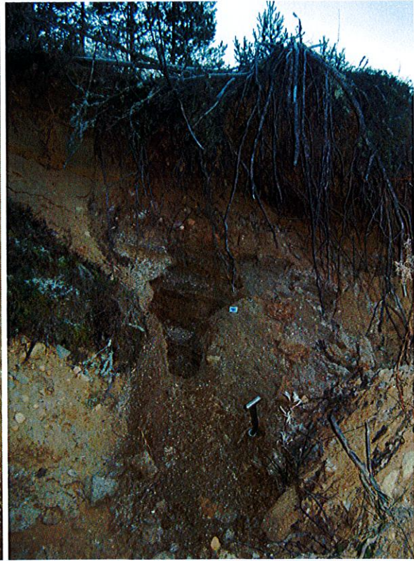
Fig. 4b och c. Skärningen där proverna togs. I botten var ett avvikande finkornigare lager med mjåla/sand. Övriga lager sand och grus. Foto: Lars Göran Spång.
