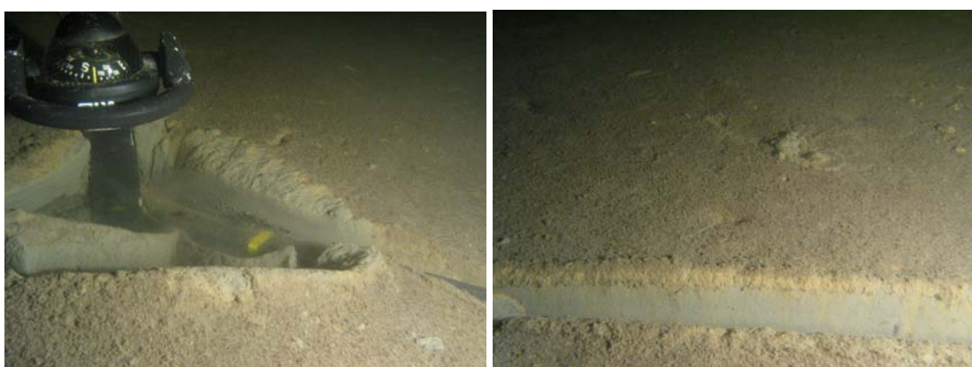
Fig. 12. Exempel på bottenyta representerande postglacial gyttjelera med recent sedimentation. Notera nedsjukningen av stativet t.h. och att stativets bottenram helt sjunkit ned i de mjuka sedimentet. Station 07-0006.
