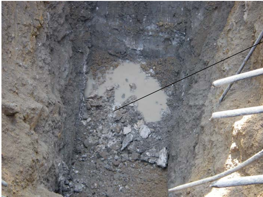
Provgrop 2. Plan berggrundsytta i botten av schakt. Berggrunden överlagras av morän.
