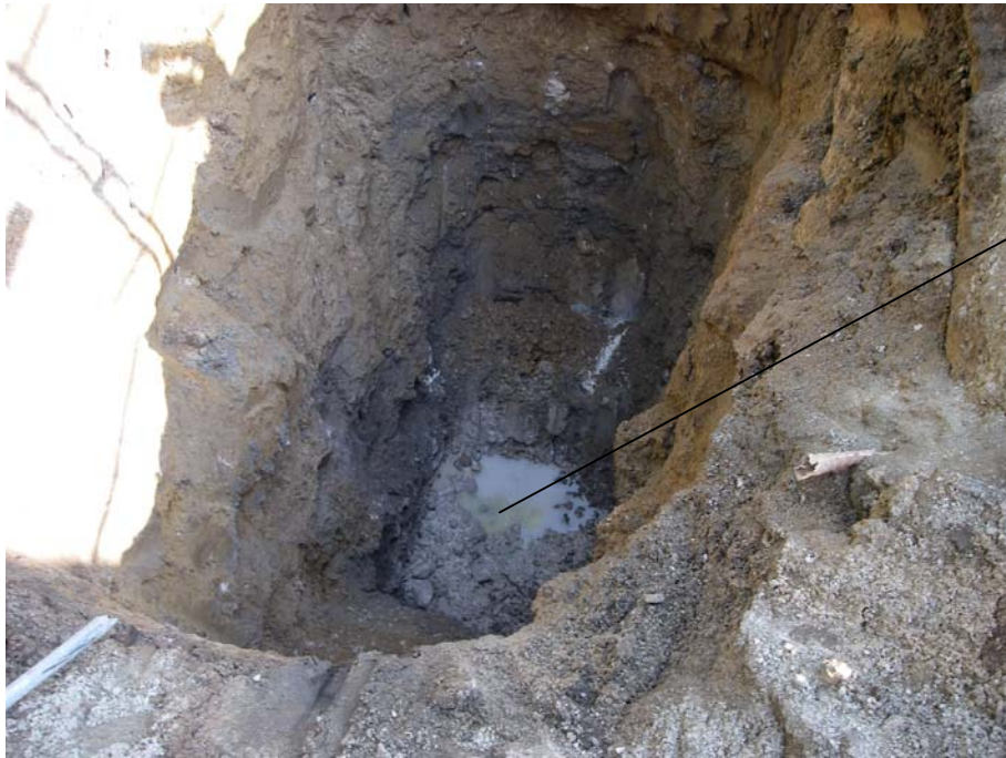
Provgrop 1. Plan berggrundsytta i botten av schakt. Berggrunden överlagras av morän.
