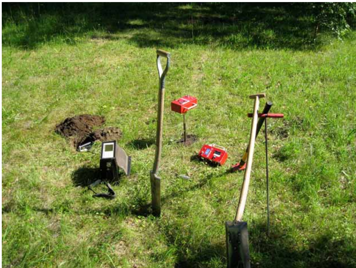
Figur 23. Markradonmätning med markusinstrument och gammadetektor vid Björketorp Marks kommun. Foto: Sven Erik Sundevall.
