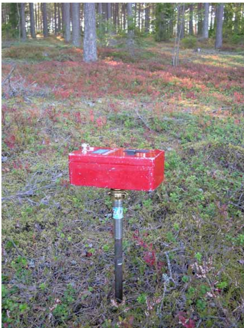
Figur 16. Emanometer med halvledare för mätning av alfastrålning från radondöttrar. Instrumentet på bilden är av typ Markus 10. Foto: Cecilia Jelinek SGU.
