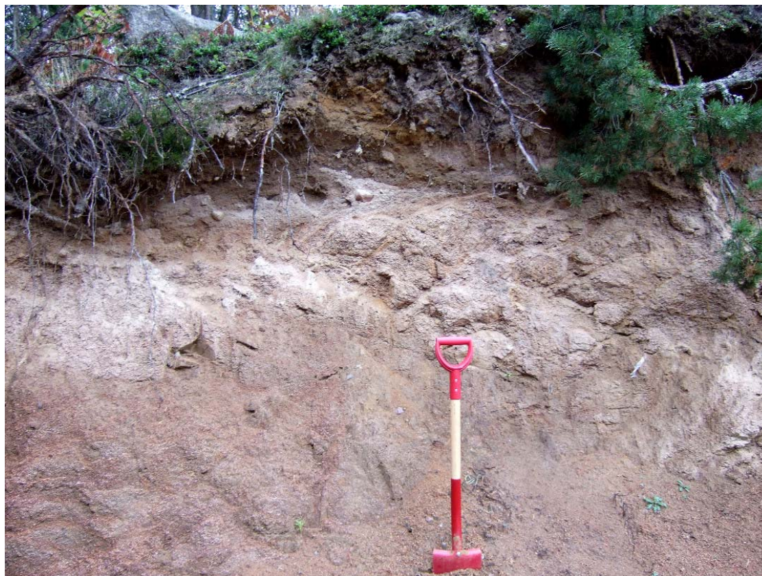
Fig. 4. Ca 0,5 m sandig morän med flikig, glacialtekoniserad kontakt till det grusvittrade berget.
