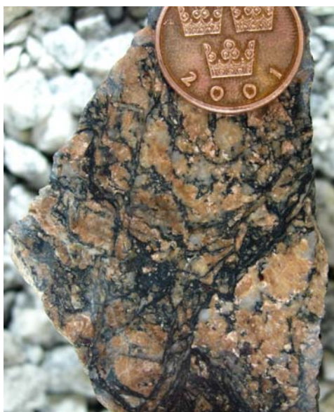
Fig. 13. Protomylonit med konjugerande set av foliationsband som sveper runt rester av fältspatporfyroklaster
