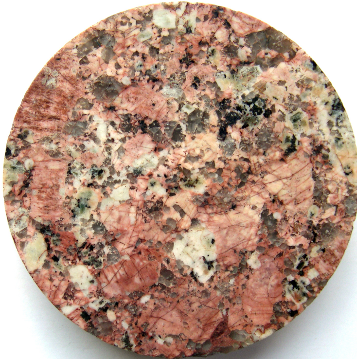
Nr 38. Granit, Månsta Granit av Dalatyp, relativt jämnt medelkornig, men med tendens till porfyrganitisk utbildning. Strörkornen består mest av pertit, underordnat också av (vit) albit.
