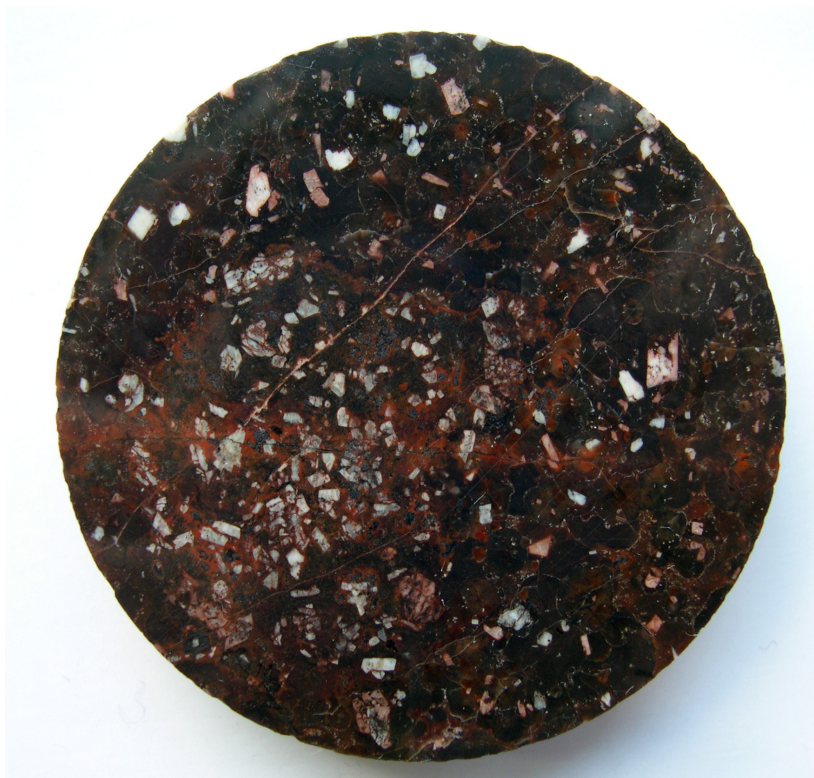
Nr 57. Dysbergporfyr, mörk En mörkare (svartbrun) varietet av nr 56, där kulstrukturen är mindre tydlig. Mörka kulor (sfärliter) framträder i en rödaktig matrix. Ojämn fördelning av fältspatströkornen, möjligen orsakad av att bergarten innehåller fragment av något olika porfyrtyper, med olika strökornshalt.
