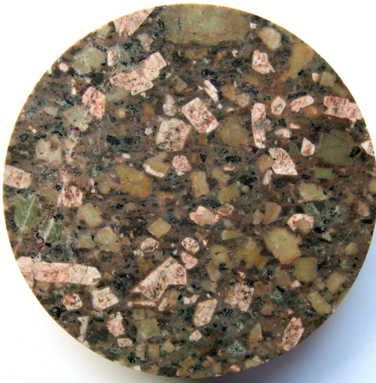
Nr 131. Strökornsrik porfyr Ovanlig porfyrtyyp med relativt stora och många fältspatströkorn (skär pertit och gråaktig albit). Pertitmantlar finns runt båda fältspattyperna. Inga ignimbritstrimmor syns. Grundmassan är relativt starkt kristalliserad (kornig).
