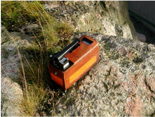
Figur 14. Med hjälp av scintillometer får man snabbt en uppfattning om strålningssituationen i ett område. Scintillometern ger ett mått på den totala gammastrålningen men kan inte skilja på strålningen från de olika förekommande isotoperna (på bilden en Scintrex BGS). Foto: Sven Erik Sundevall SGU.
