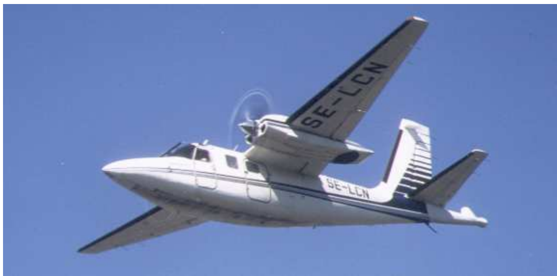
Figur 12. Flyggeofysiska mätningar utförs numera på cirka 60 meters höjd över markytan och med ett flyglinjeavstånd av cirka 200 meter. Foto: Erik Starbäck, SGU.
