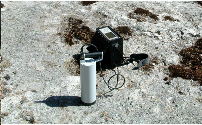
Figur 15. Mätning med gammaspektrometer. Gammaspektrometern ger en detaljerad bild av gammastrålningen från de olika isotoperna (på bilden en Exploranium GR-320). Foto: Sven Erik Sundevall SGU.
