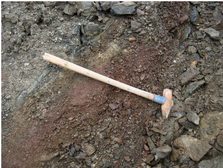
Fig. 28 Sprödtektonisk zon i tonalit som är fyllosilikatrik och rödfärgad av hematit. Bergarten är kraftigt folierad och uppkrossad [6614606; 1568781].
