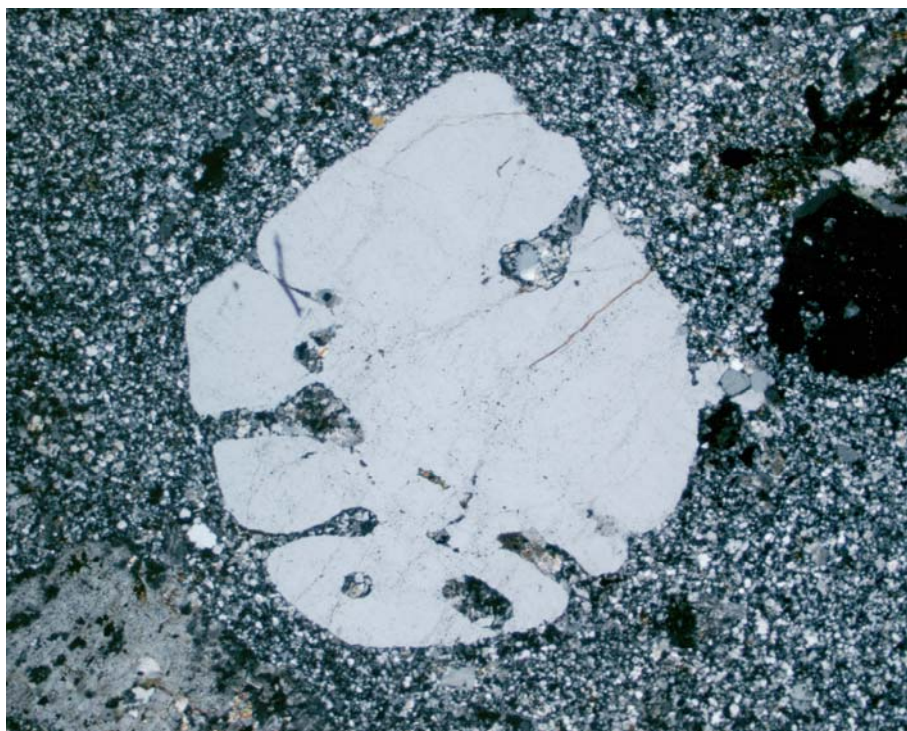
Fig. 4. Detalj av mikrofotot i fig. 3, visande ett korroderat kvartsströckorn med tendens till bipyramidal kristallform. Kornigheten i grundmassan framträder tydligt. Bildyta ca 3 x 4 mm. Korsade nicoler. Foto Sven Lundqvist, SGU Uppsala.
