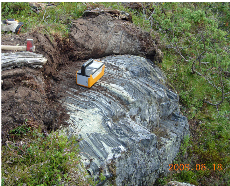
Fig.11. Spektrometermätning på kvartsbandad järnmalm ("Banded Iron Formation", BIF) norr om Allebuouda (7361911/620755).
